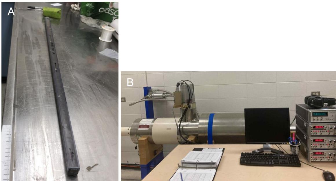
Figure 17. A. U-channel sous-échantillonné dans une carotte de sédiments. B. Magnétomètre cryogénique 755SRM-1.65 de 2G Enterprises à l'ISMER.
