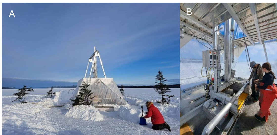
Figure 15. Photos de la campagne d'échantillonnage à Grand Lake au Labrador. A. Plateforme de carottage sur le lac vue de l'extérieur. Les arbres servent de signalisation pour les personnes qui circulent sur le lac. B. Déploiement du carottier à percussion avec Bruno Cayouette, vue de l'intérieur de la tente (photo de Quentin Beauvais).
