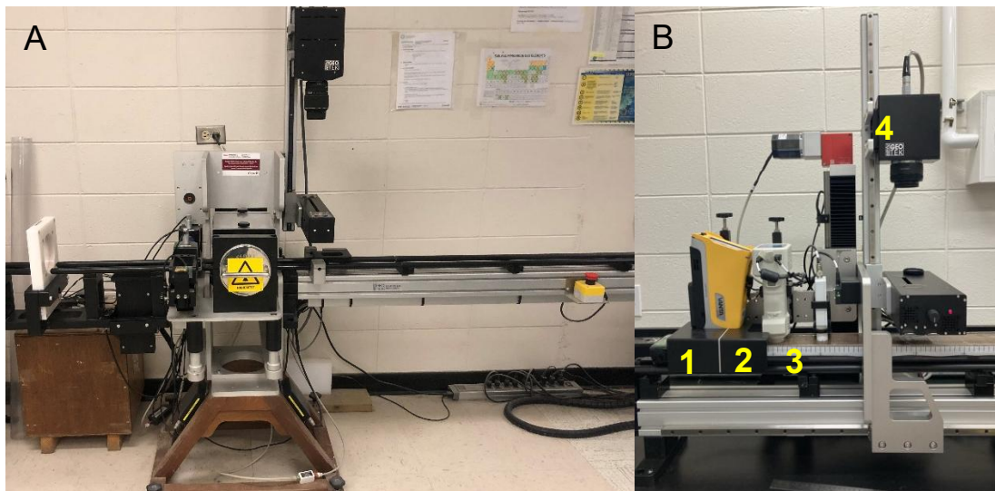
Figure 16. Photos du banc MSCL de GEOTEK à l'ISMER. A. Banc utilisé pour les carottes entières et ouvertes. B. Montage avec le pistolet XRF (1), le spectrophotomètre (2), la susceptibilité magnétique (3) et le système d'imagerie digitale (4) pour les mesures sur les demi-sections ouvertes.
