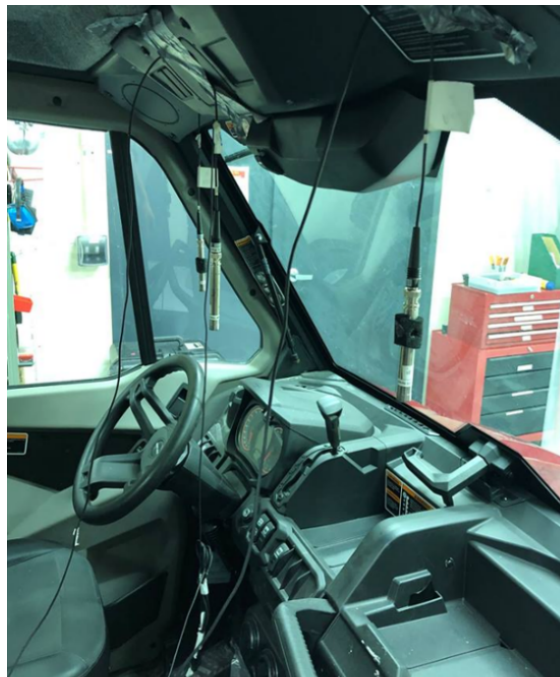
Figure 28 : Mesure de pression acoustique à l'intérieur de la cabine à l'aide de microphones
