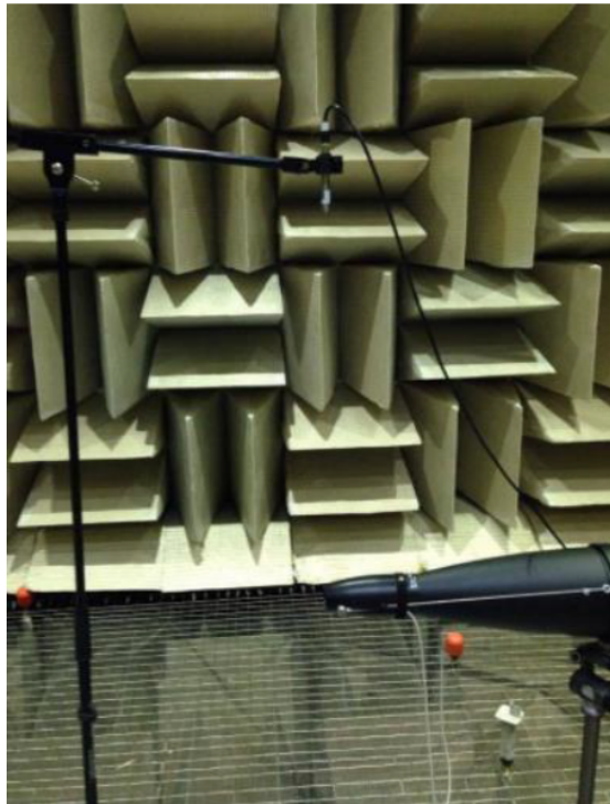
Figure 15 : La mesure du SPL pour la validation de la directivité de la source
