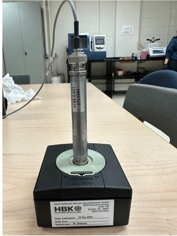
Figure 13 : Microphone de Type 4189-A-021 de Brüel & Kjær
