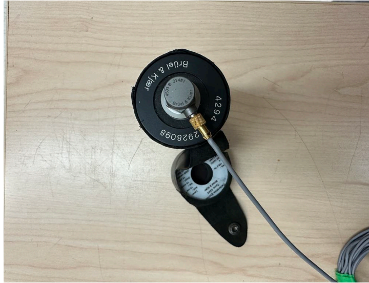
Figure 12 : Accéléromètre de Type 4533-B de Brüel & Kjær
