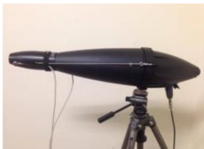
Figure 14 : Source sonore omnidirectionnelle (Brüel & Kjær de type 4295)
