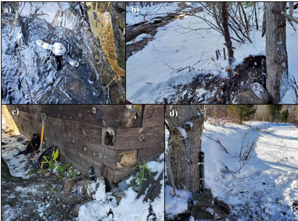
Figure 19. Capteurs de pression installés sur le cône alluvial de la coulée à Layoutte: a) MSPAP b) MSPAM c) MSPPO d) MSPAV
