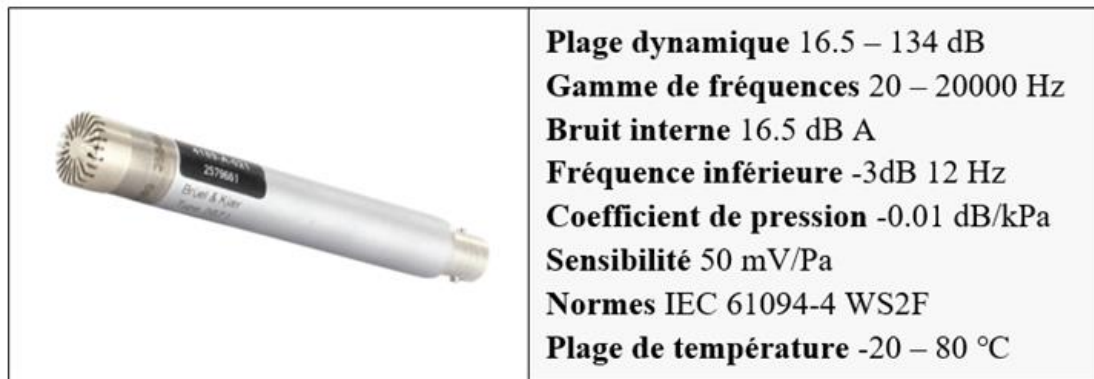
Figure 29: Microphone TYPE 4189-A-021 utilisé pour les mesures [69]
