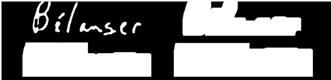
Figure 14 : Effet de dilations succinctes afin de joindre les caractères en un seul contour. L'image permet de comparer une case ayant après 0, 5, 10 et 15 dilations successives.
