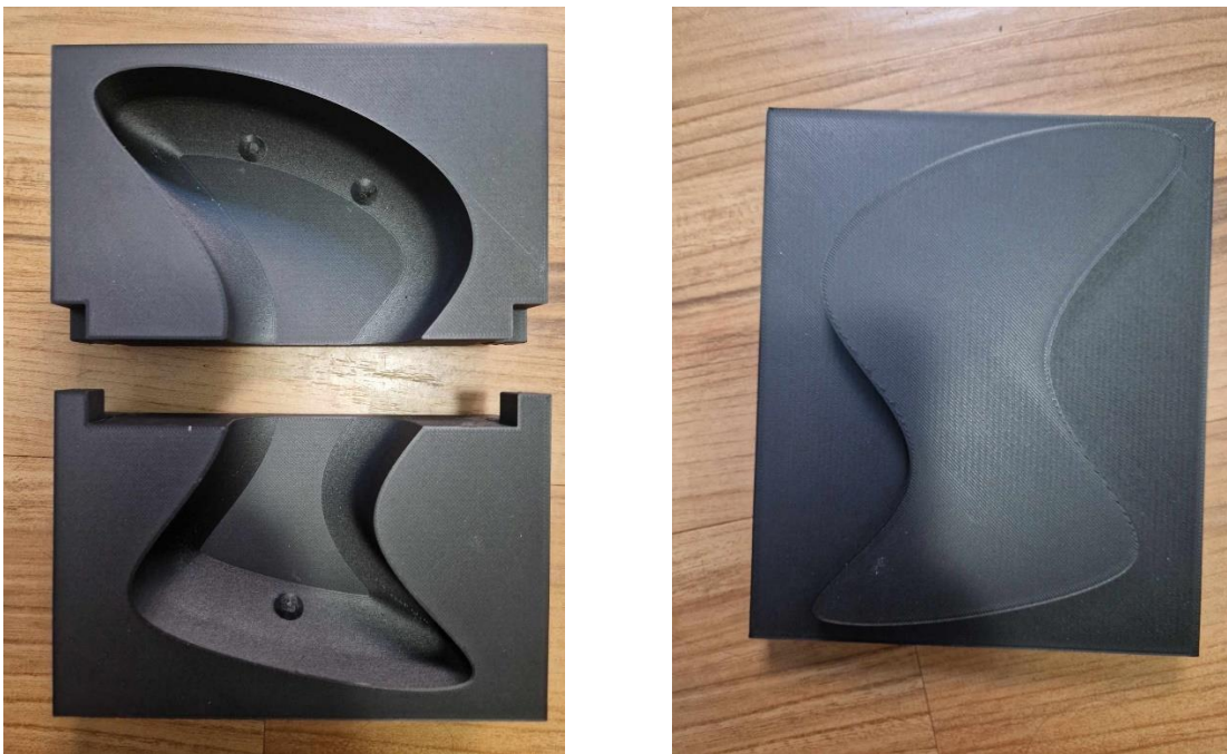
Figure 60 : Moule de la prise d'escalade, à gauche parties inférieures, à droite partie supérieure
