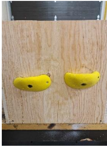
Figure 41 : Prises d'escalade accrochées sur une plaque de bouleau de 18 mm
