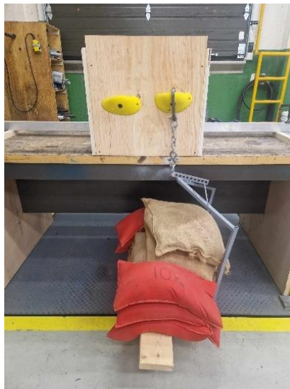
Figure 42 : Système d'accroche lesté avec des sacs de sable
