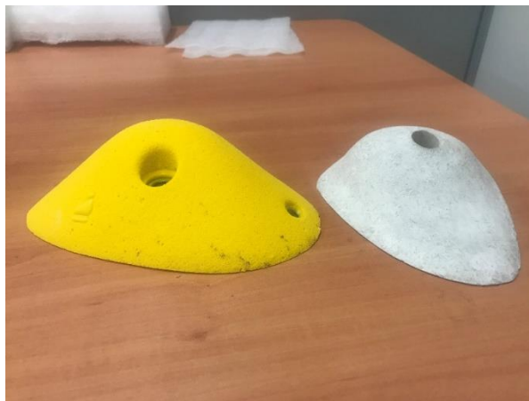
Figure 19 :Prise d'escalade en polyuréthane (à gauche) et Elium® 150 (à droite)
