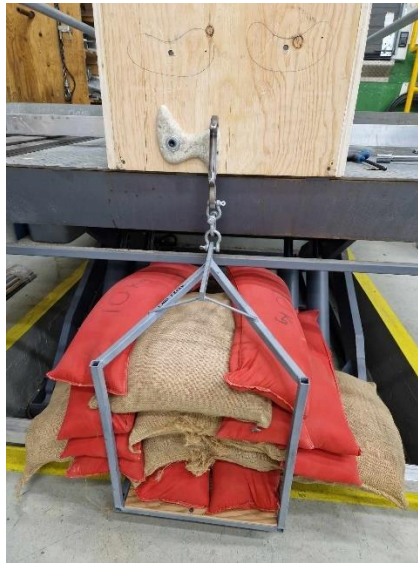
Figure 61 : Test de la norme NF EN 12 572 pour les prises d'escalade en composite
