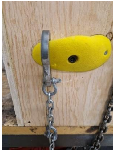
Figure 44 : Positionnement du crochet pour réaliser le test de rotation et le test d'arrachement de la norme NF EN 12 572
