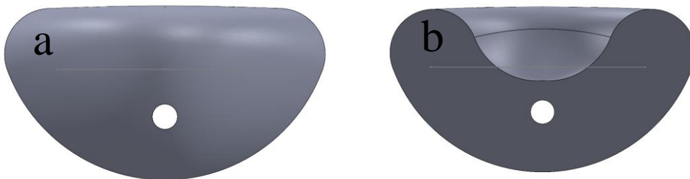
Figure 50 : Modèle numérique d'une reproduction de prise du commerce sur Solidworks; a : face avant, b : face arrière
