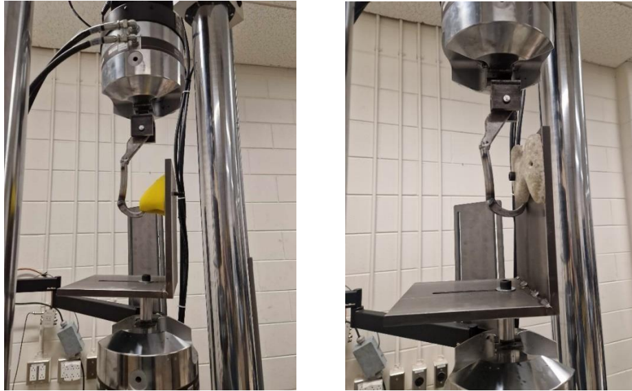
Figure 45 : Système de test pour obtenir la limite de résistance des prises d'escalade; à gauche en polyuréthane et à droite en composite
