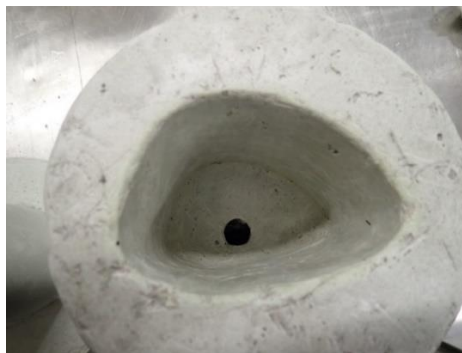
Figure 17 : Moule expérimental de prises d'escalade vide pour la résine Elium® 150
