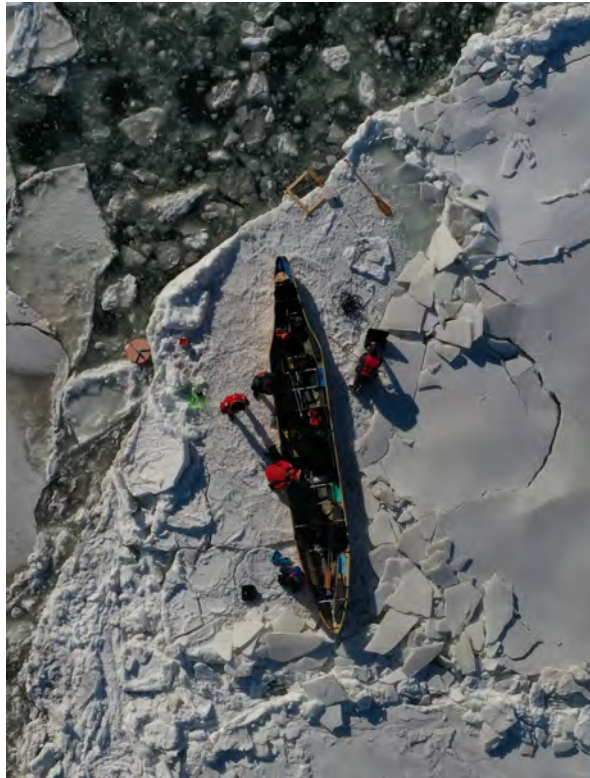
FIGURE 1 – Canot à glace déployé dans la MIZ, vu d’un drone. On y voit 5 membres de l’équipage et des instruments de mesures, tel un ADCP (Acoustic Doppler Current Profiler) pour quantifier les fluctuations de vitesse, près de Saint-Fabien-sur-mer, Québec, Canada, le 12 février 2020. On peut aussi y observer la diversité de topographie, d’épaisseur et de taille des différents floes présents.
