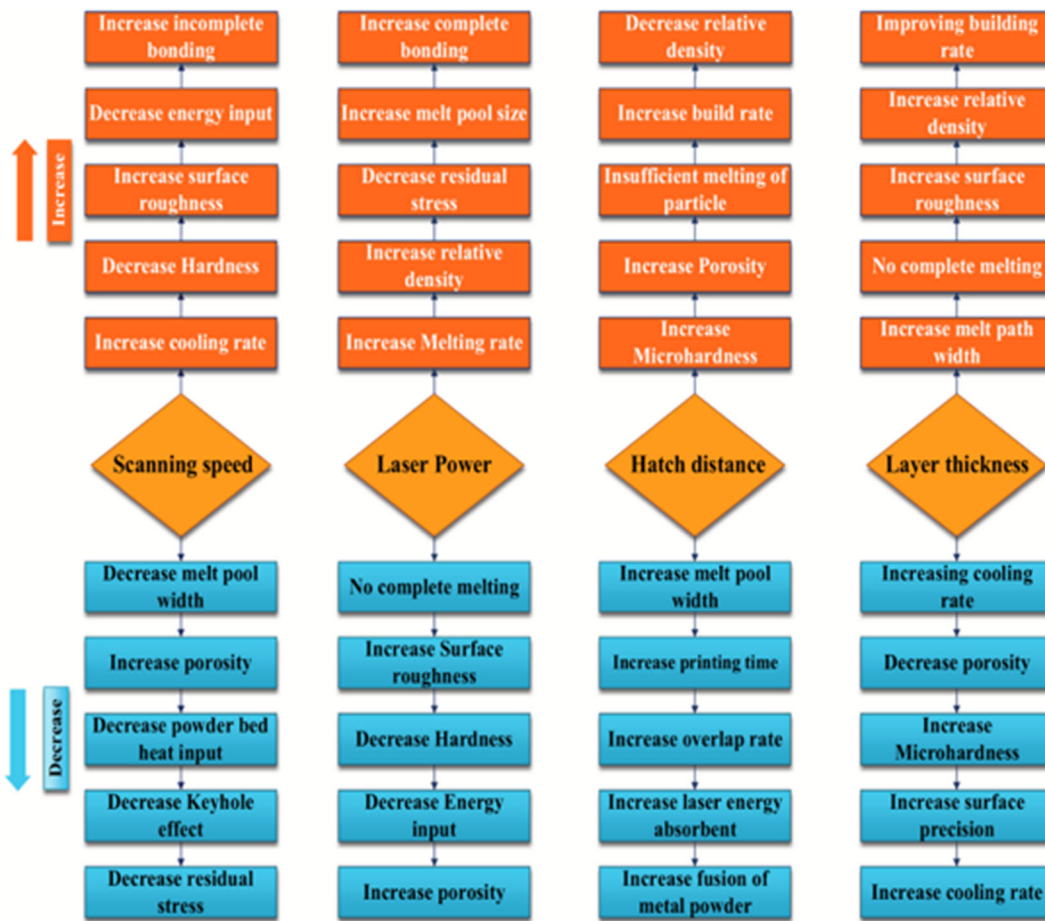
Figure 0- 9: Effet des paramètres de processus fusion sélective au laser [35].
