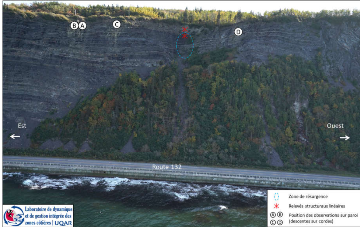
Figure 17. Paroi rocheuse avec résurgence du site étudié (GM) avec la position de la zone de résurgence, des relevés structuraux et des points d'observations sur la paroi de chaque côté de l'encoche en amphithéâtre.
