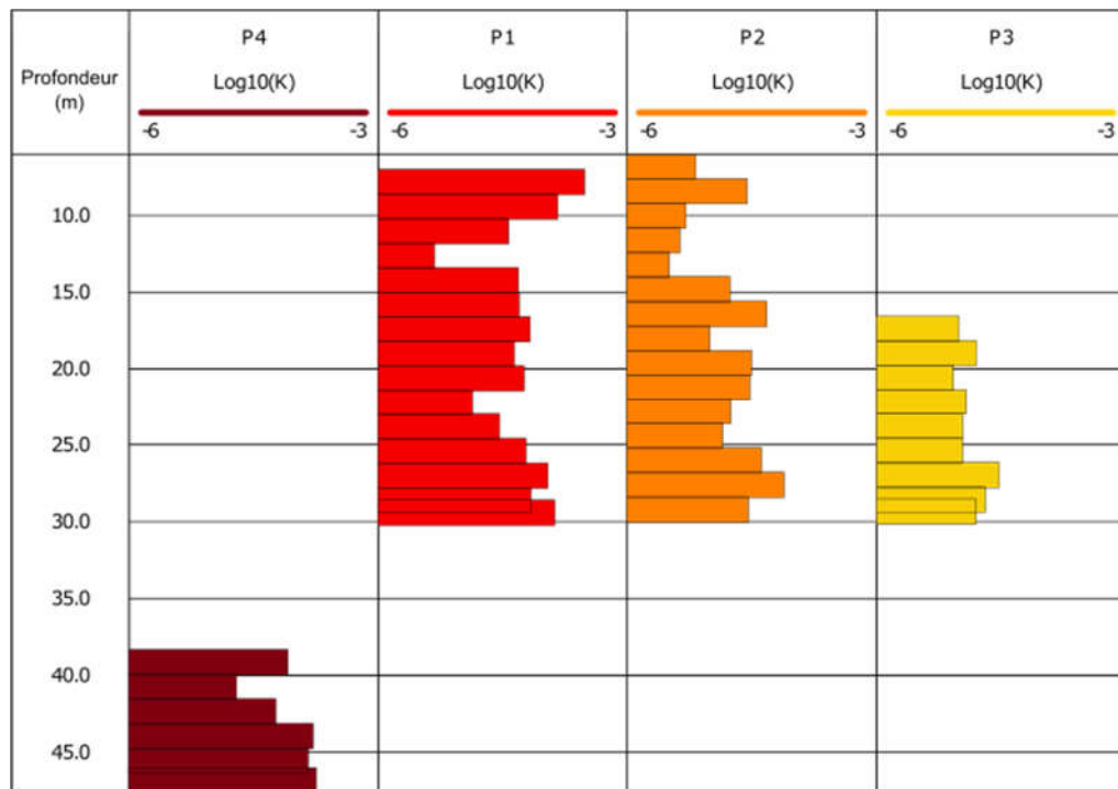
Figure 24. Logarithme de la conductivité hydraulique du roc fracturé obtenue pour chaque intervalle de 1,60 m testé avec les essais à choc hydraulique entre obturateurs dans les quatre puits.
