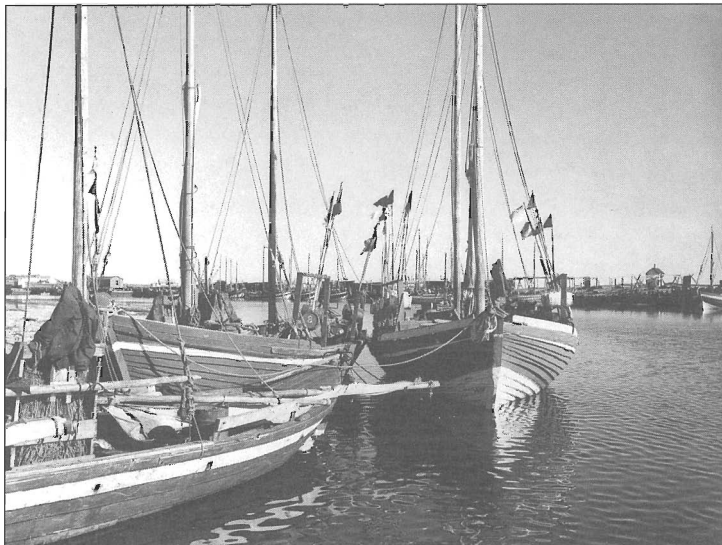
Grande-Rivière, 1949, détails d'un bordé plutôt inégal (photographie de Gustave Bédard, Archives nationales du Québec à Québec).
