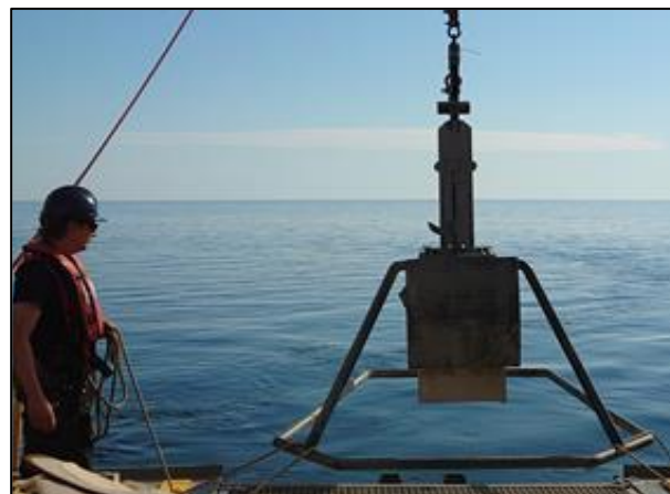
Figure 2-3. Déploiement du carottier à boîte sur le pont du N/R Coriolis II lors de la mission SLIDE-2020.
