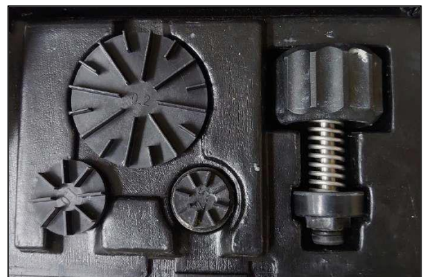
Figure 2-12. Hand shear-vane utilisé pour mesurer de la résistance au cisaillement non-drainé des argiles.
