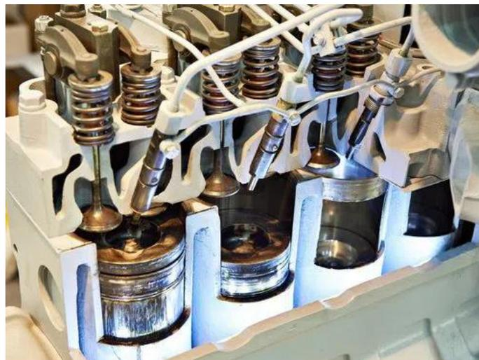
Figure 5 : Cylindres et soupapes [9]
