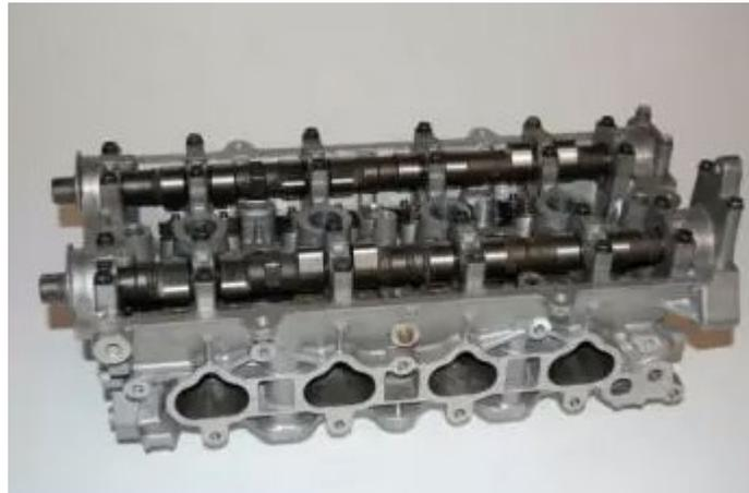
Figure 4 : Culasse d'un moteur Diesel [5]
