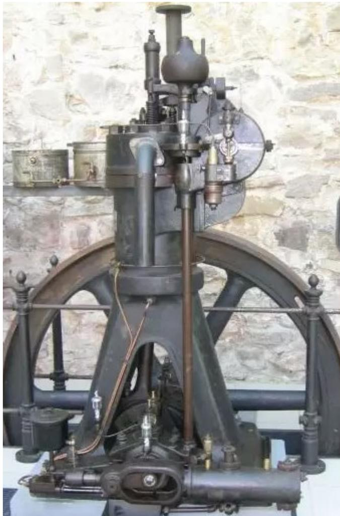
Figure 1 : 1<sup>er</sup> modèle du moteur Diesel [5]
