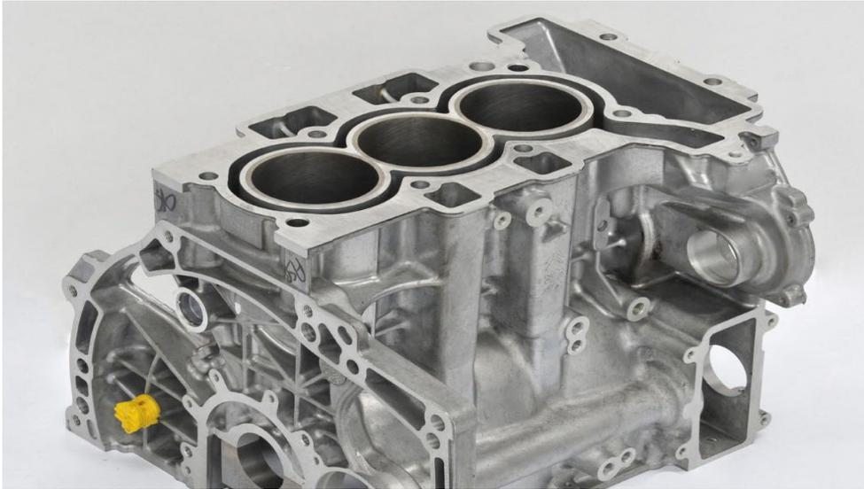
Figure 2 : Bloc d'un moteur [6]
