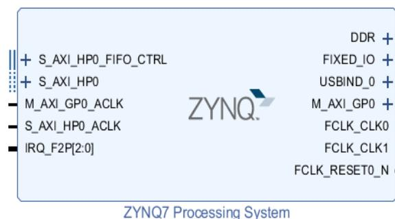
Figure 3.19 : Système de traitement ZYNQ7
