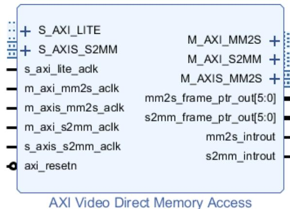
Figure 3.20 : Bloc d'accès direct à la mémoire vidéo (VDMA)
