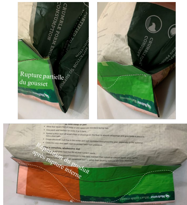
Figure 30 : Répartition du produit dans le sac après rupture partielle de la soudure interne
