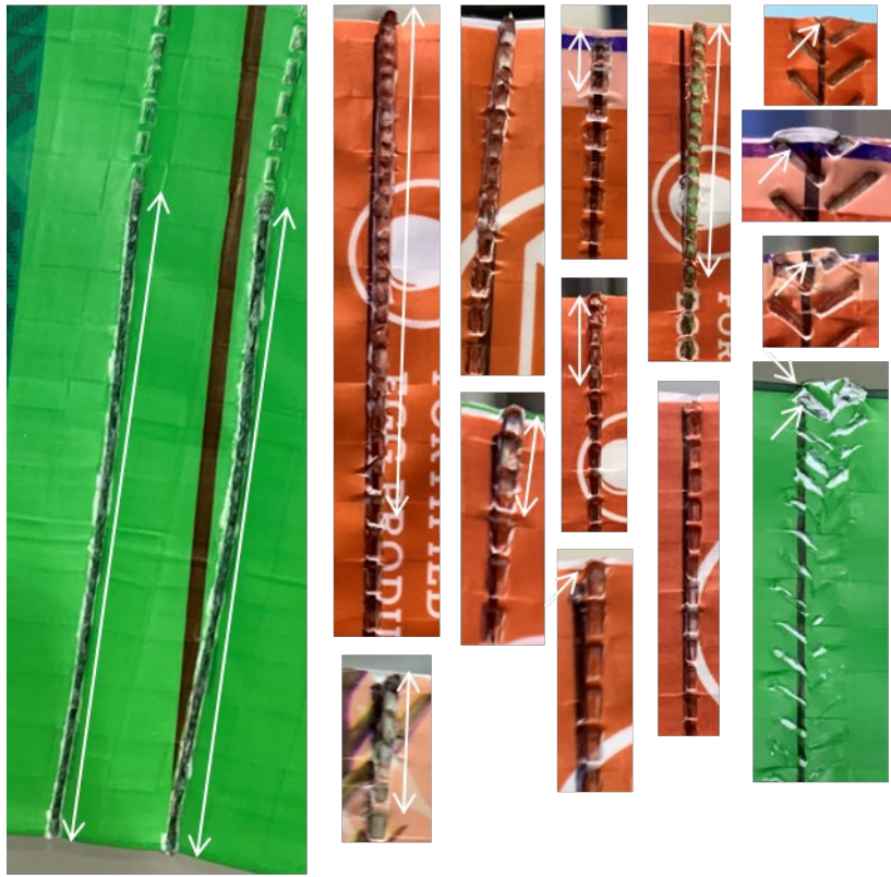
Figure 51 : Défaut 4 : Arrachement du plastique et amorce des soudures à la première extrémité des échantillons
