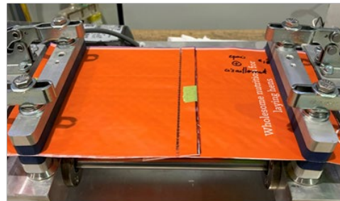
Figure 36 : Répartition des sollicitations mécaniques en fonction de la position de la soudure
