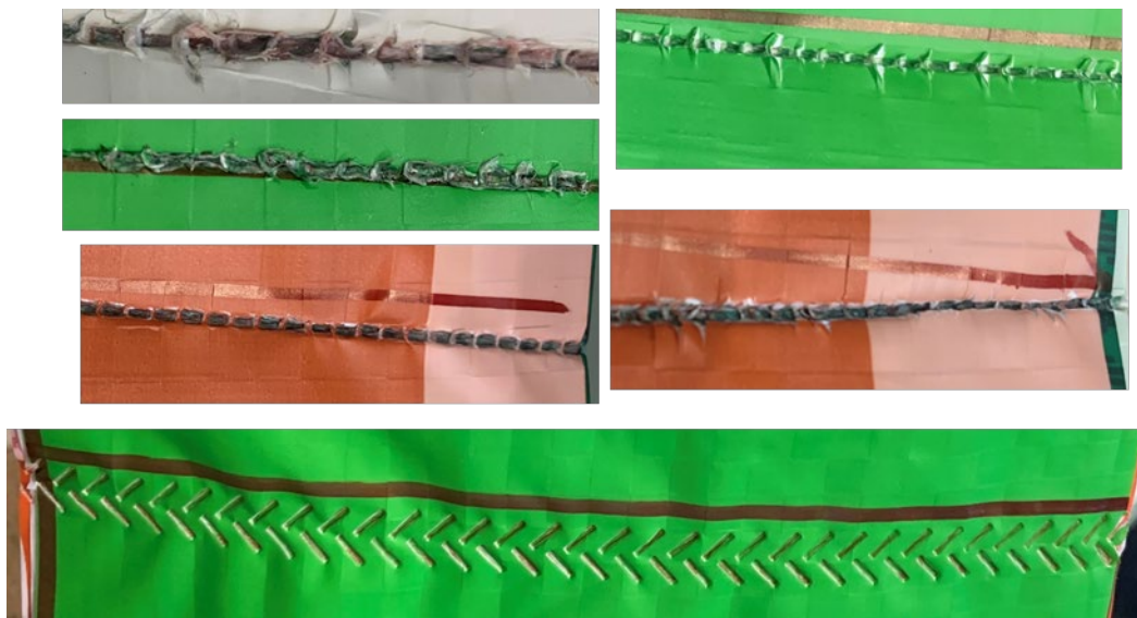
Figure 52 : Défaut 5 : Plissement du matériau autour de la fermeture
