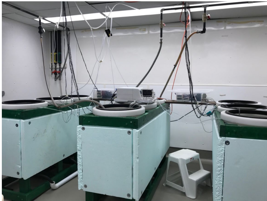
Figure 12 : Installation des moules équipées de valvomètres pour les expériences en laboratoire.
