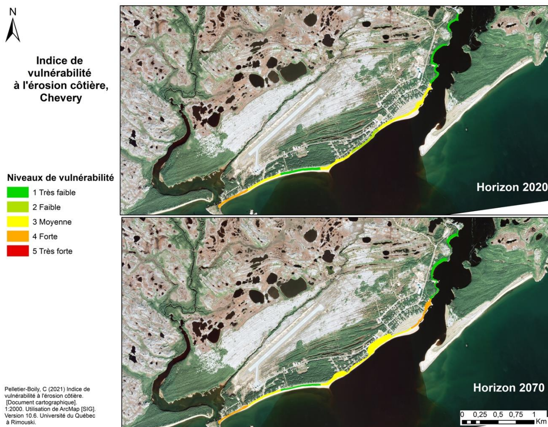
Figure 57: Indice de vulnérabilité de la zone côtière à l'érosion - Chevery
