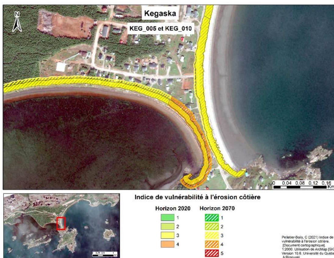
Figure 47: Indice de vulnérabilité de la zone côtière à l'érosion - segment KEG_005 et KEG_010
