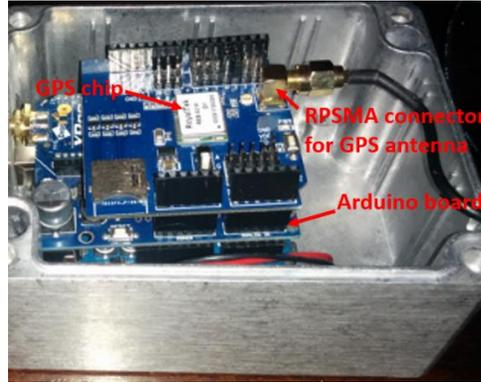
Figure 89. Le module GPS et la carte à microcontrôleur embarqués dans le train
