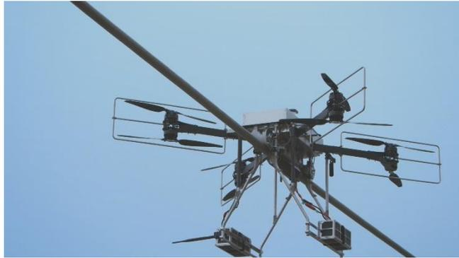
Figure 8. Drone d'Hydro-Québec pour l'inspection des lignes électriques [34]
