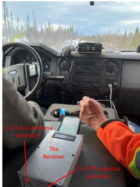
Figure 107. Récepteur dans le pick-up Hi-Rail
