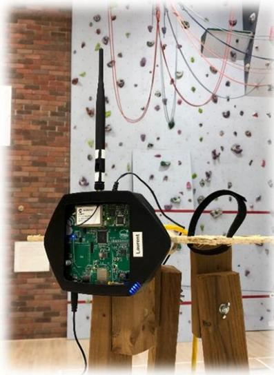
Figure 186. Passerelle The Things Gateway LoRa 915 MHz et Wifi 2.4 GHz
