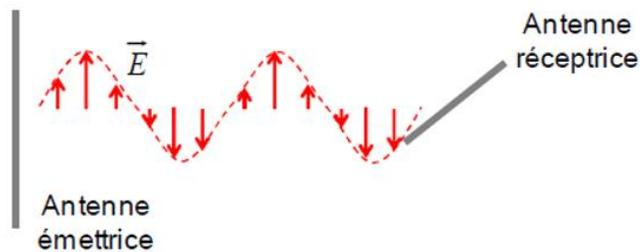
Figure 29. Antennes émetteur et récepteur à 90 degrés
