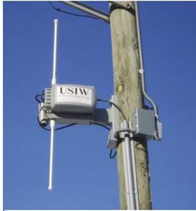
Figure 44. Photo antenne demi-onde
