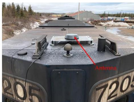
Figure 105. Antennes implantées sur le toit de la locomotive
