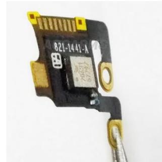
Figure 54. Antenne patch pour téléphone intelligent
