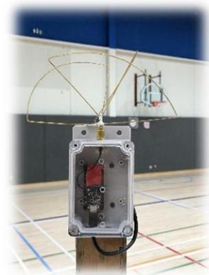
Figure 185. Nœud LoRa avec antenne LHCP
