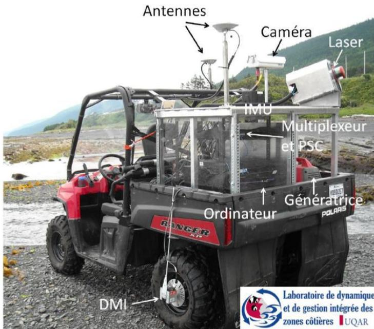
**Figure 73. Système mobile de LiDAR terrestre (SMLT)**
