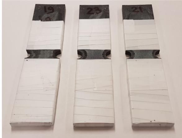
Figure 17. Emballage en téflon des éprouvettes de fatigue
