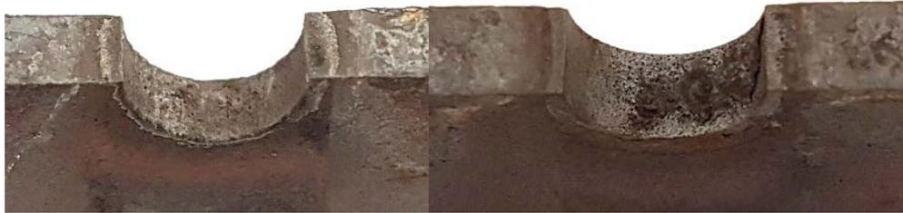
Figure 69. Macrographie des entailles après traitement chimique des éprouvettes de fatigue modèle U (face usinée à gauche et imprimée à droite)
