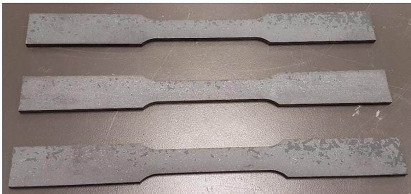
Figure 38. Éprouvettes de traction après durcissement structural
