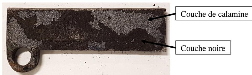
Figure 44. Éprouvette en cours de décapage non rincée
