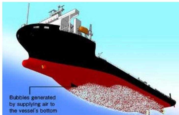
Figure 39. La technologie à bulles [54].
