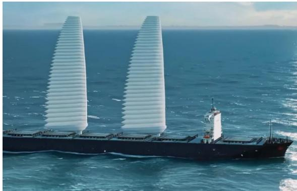
Figure 28. Le concept de Michelin repose sur des voiles gonflables [39].
