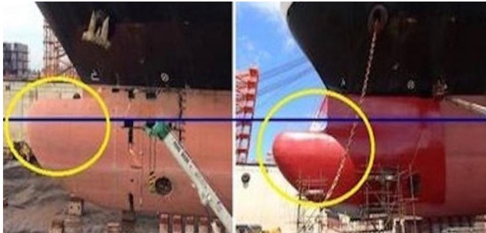
Figure 41. Arc bulbeux avant et après modification [54].
