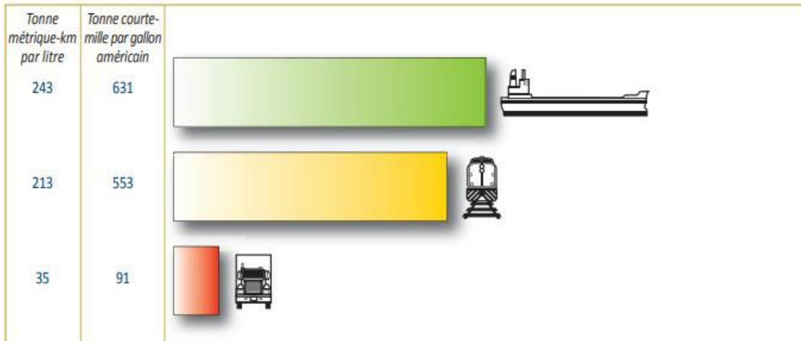
Figure 3. Comparaison de l'efficacité énergétique – Flotte combinée du réseau Grands Lacs-Voie maritime (2010) [3].
