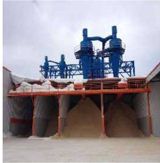
Figure 7 Système de dépoussiérage externe [4]
