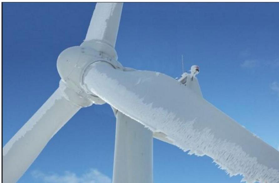
Figure 1 : Pales d'éoliennes givrées [12]
