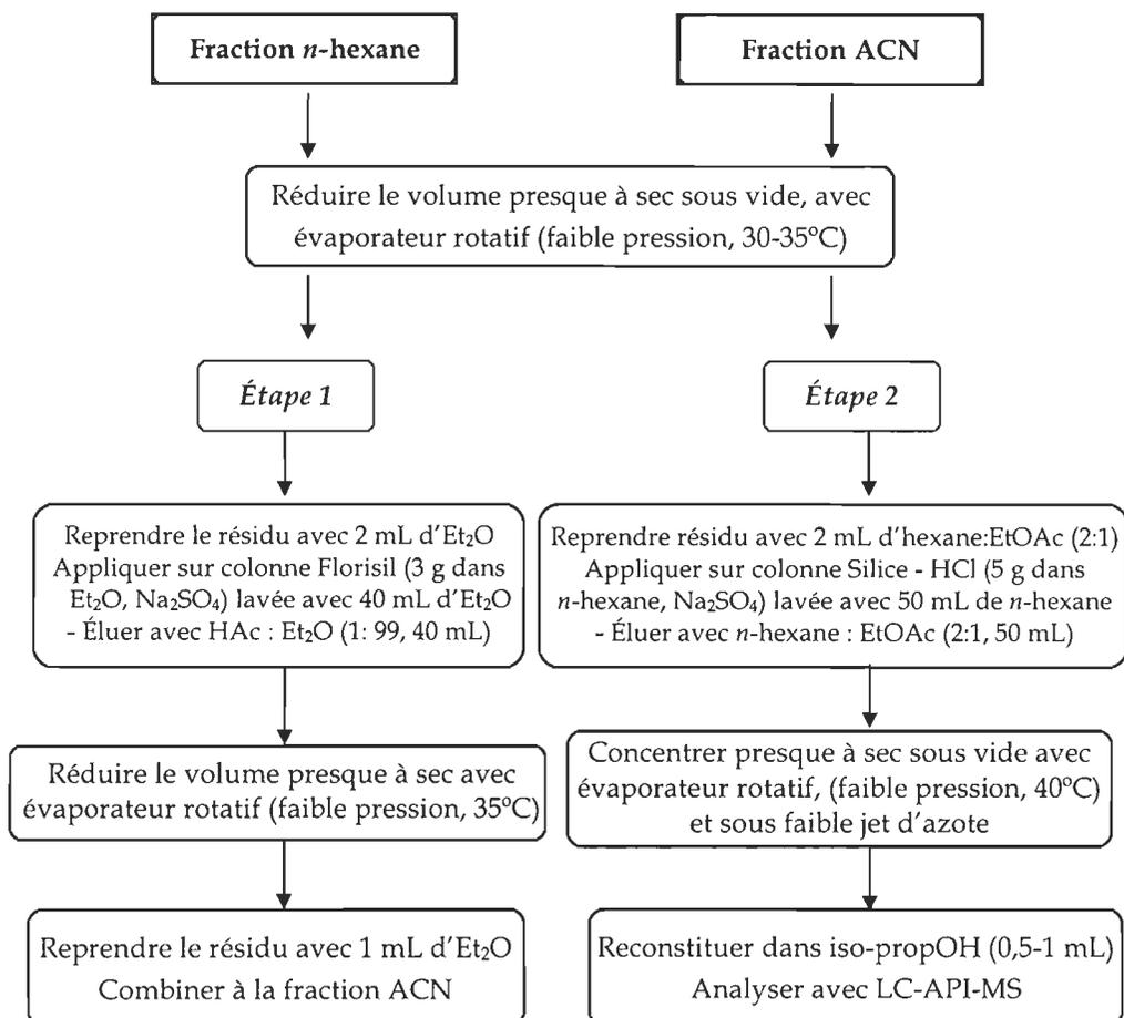
**Figure 1. (Suite)** Protocole d'extraction des butylétains des foies de poissons et des tissus de moules, selon la procédure de Suzuki et al. (1992).
