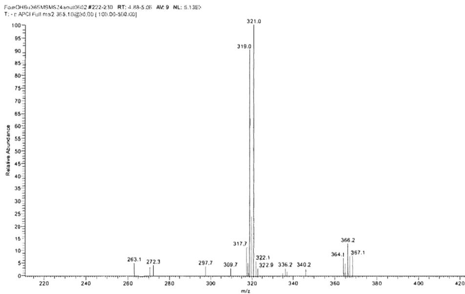
**Figure 11.** Spectre de masse MS/MS en APCI négative de l'extrait de foie de poisson exposé au 4-OHBuDBT révélant les ions fragments du pic à  $m/z$  365, en mode de balayage complet du MS [ $m/z$  100-500] en appliquant une énergie de collision de 30% (unité arbitraire) et une fenêtre d'isolation de masse de 6 amu.
