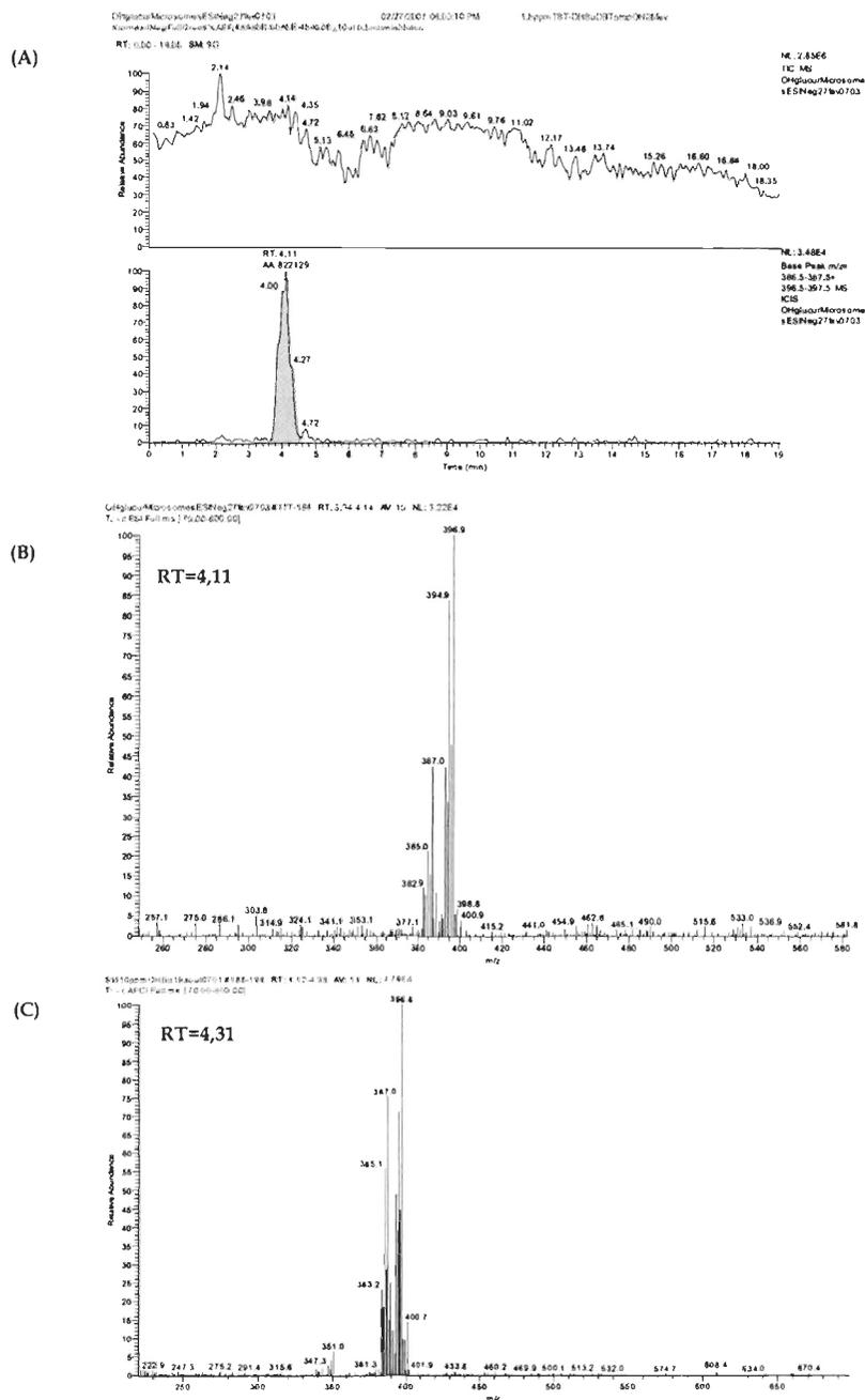
**Figure 4.** Chromatogrammes typiques (A) du standard 4-OH-BuDBT (RT= 4,11 min; 1,5  $\mu\text{g}\cdot\text{mL}^{-1}$ ) élué sur une colonne Kromasil C-18 et ses spectres de masse ESI-MS (B) et APCI-MS (C), acquis en modes d'ionisation négative et de balayage complet du MS [ $m/z$  70-800].
