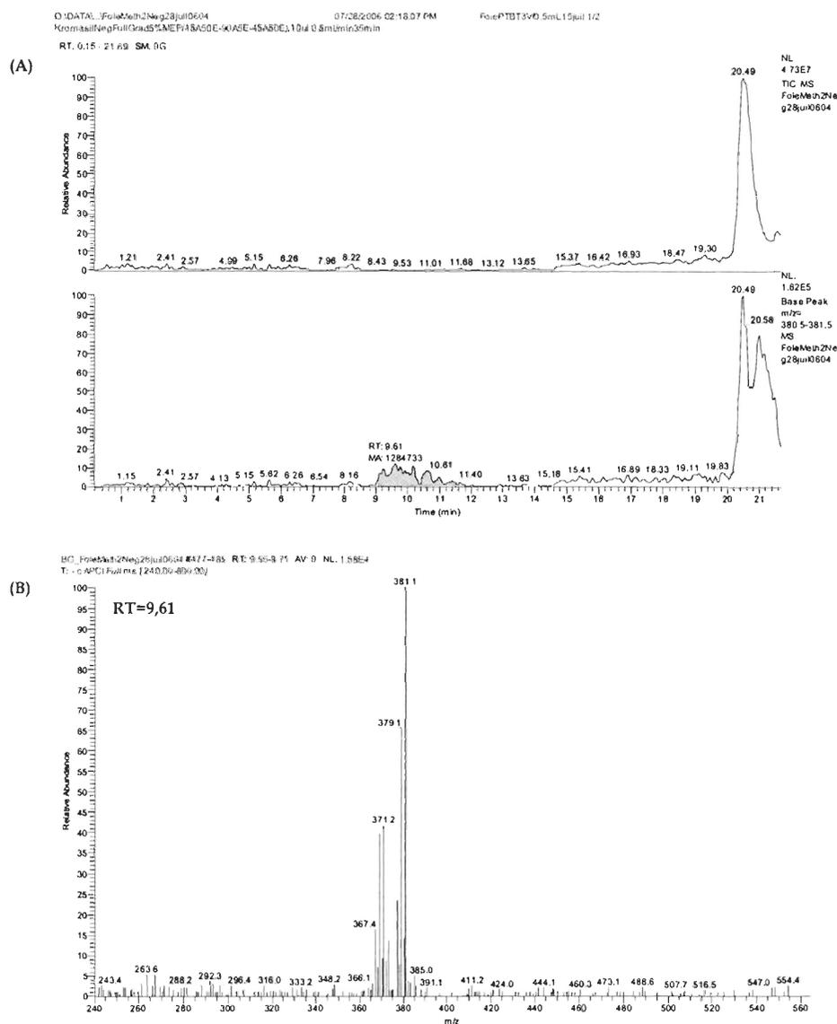
**Figure 12.** Chromatogrammes (A) et spectre de masse APCI négative (B) de l'extrait de foie de poisson exposé au TBT. Le(s) composé(s) inconnu(s) à RT= 9,61 min avec  $m/z$  371 et  $m/z$  381, en mode de balayage complet du MS [ $m/z$  240-800].
