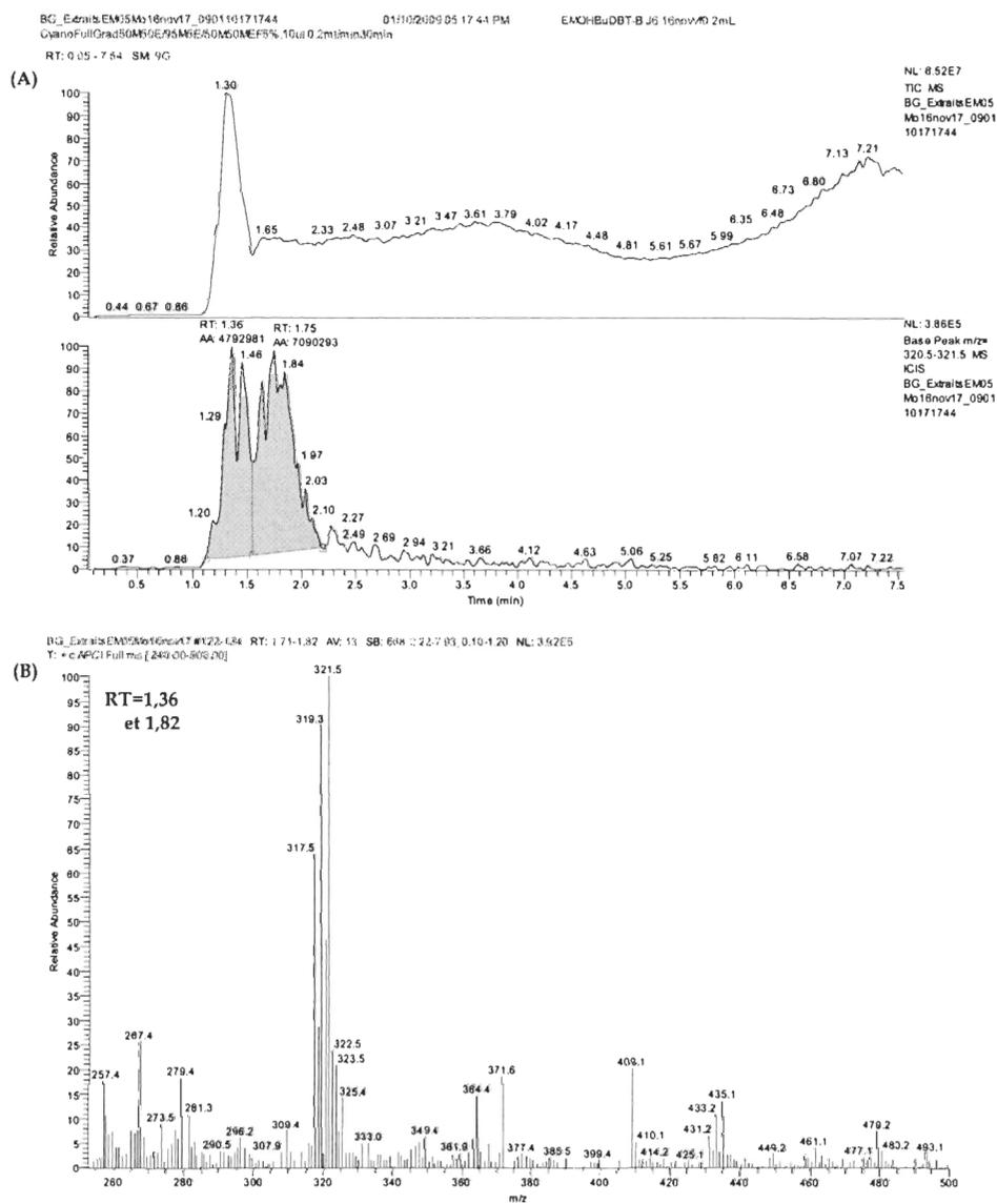
**Figure 4.** Chromatogrammes (A) et spectres de masse ESI négative (B) d'un extrait d'eau de mer ayant servi à l'exposition des moules au 4-OHBUDBT, au jour 6. Le pic inconnu à RT= 1,36 et 1,82 min (méthode avec la colonne Discovery®Cyano) correspond à  $m/z$  321 avec l'ion adduit à  $m/z$  435, en mode de balayage complet du MS [ $m/z$  240-500].
