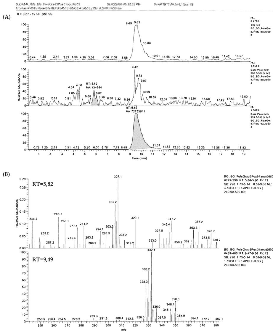
**Figure 11.** Chromatogrammes (A) et spectres de masse APCI positive (B) de l'extrait de foie de poisson exposé au TBT (RT= 9,49 min et  $m/z$  332 et 350) et le métabolite de phase I, le OHBuDBT (RT= 5,82 min et  $m/z$  307, 345), en mode de balayage complet du MS [ $m/z$  240-800].
