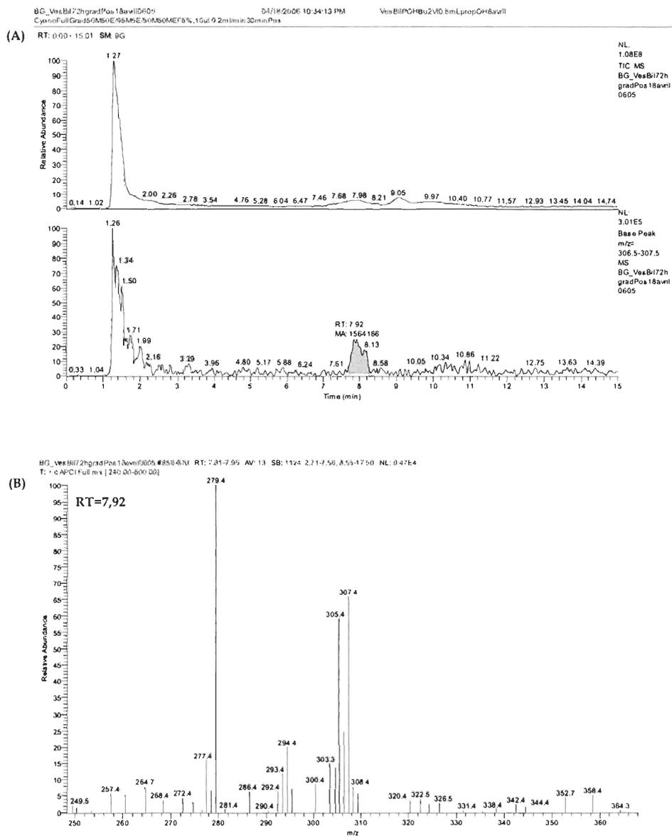
**Figure 13.** Chromatogrammes (A) et spectre de masse APCI positive (B) de l'extrait de vésicule biliaire de poisson exposé au 4-OHBUDBT révélant la présence d'un pic à RT= 7,92 min, correspondant à l'ion à  $m/z$  307, en mode de balayage complet du MS [ $m/z$  240-500].
