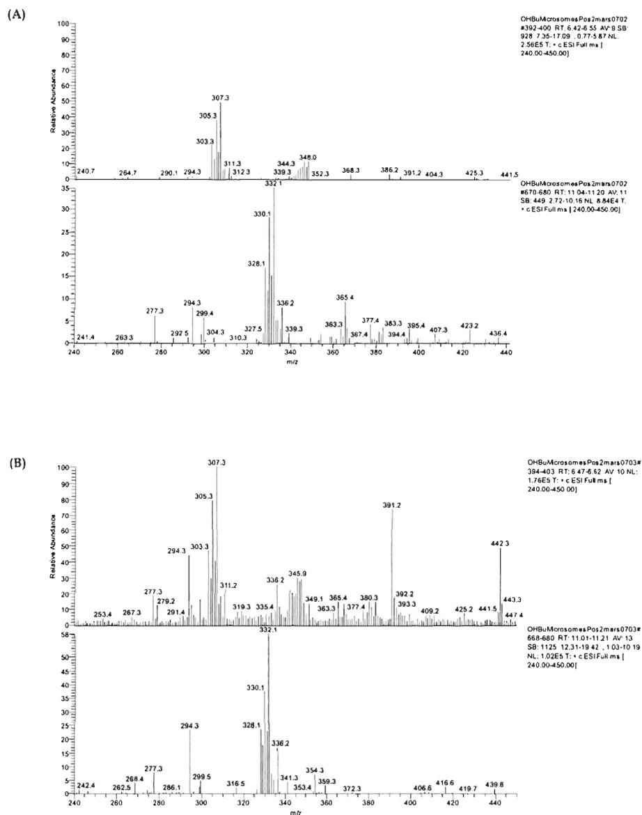
**Figure 1.** Spectres de masse ESI positive des extraits de microsomes de foie de poissons incubés pendant 3 h avec du 4-OHBuDBT ( $m/z$  307), sans cofacteur UDP-GA (A) et avec UDP-GA (B), en mode de balayage complet du MS [ $m/z$  240-450]. Noter la présence de l'ion à  $m/z$  332 caractéristique du TBT
