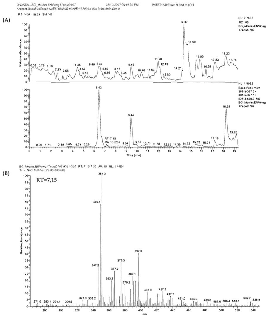
**Figure 8.** Chromatogrammes (A) et spectres de masse APCI négative (B) d'un extrait de tissus de moules ( $n=2$ ) exposées 15 jours au TBT, et le composé à RT= 7,15 min avec  $m/z$  351, 365, 389 et 397, en mode de balayage complet du MS [ $m/z$  70-800]. Noter l'absence du pic à RT= 6,01 min présent dans la figure 7 (Moules exposées 96 h).
