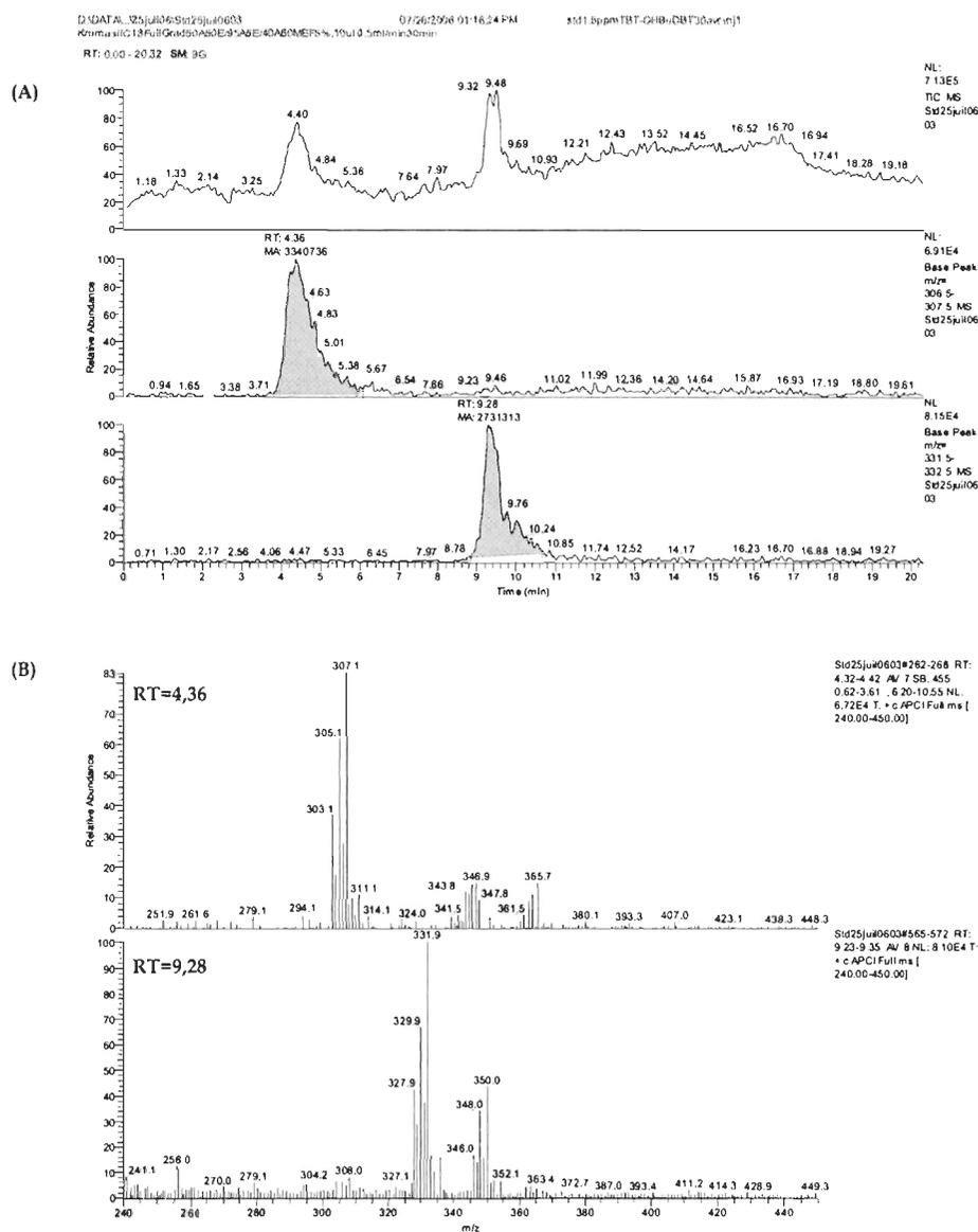
**Figure 9.** Chromatogrammes (A) en utilisant le second gradient d'élu­tion sur la colonne Kromasil C-18 et les spectres de masse APCI (B) en mode d'ionisation positive des standards (1,5 µg.mL<sup>-1</sup>) du 4-OHBuDBT (RT= 4,36 min) et du TBT (RT= 9,28 min), acquis en mode de balayage complet du MS [*m/z* 240-450].
