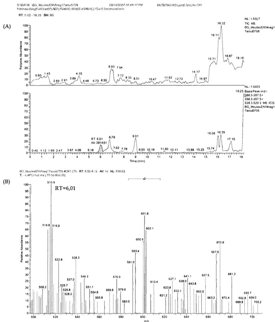
**Figure 7.** Chromatogrammes (A) et spectres de masse APCI négative (B) d'un extrait de tissus de moules ( $n=2$ ) exposées 96 h au TBT, et le métabolite non identifié à RT= 6,01 min, avec les ions à  $m/z$  517 et  $m/z$  603 en mode de balayage complet du MS [ $m/z$  70-800].
