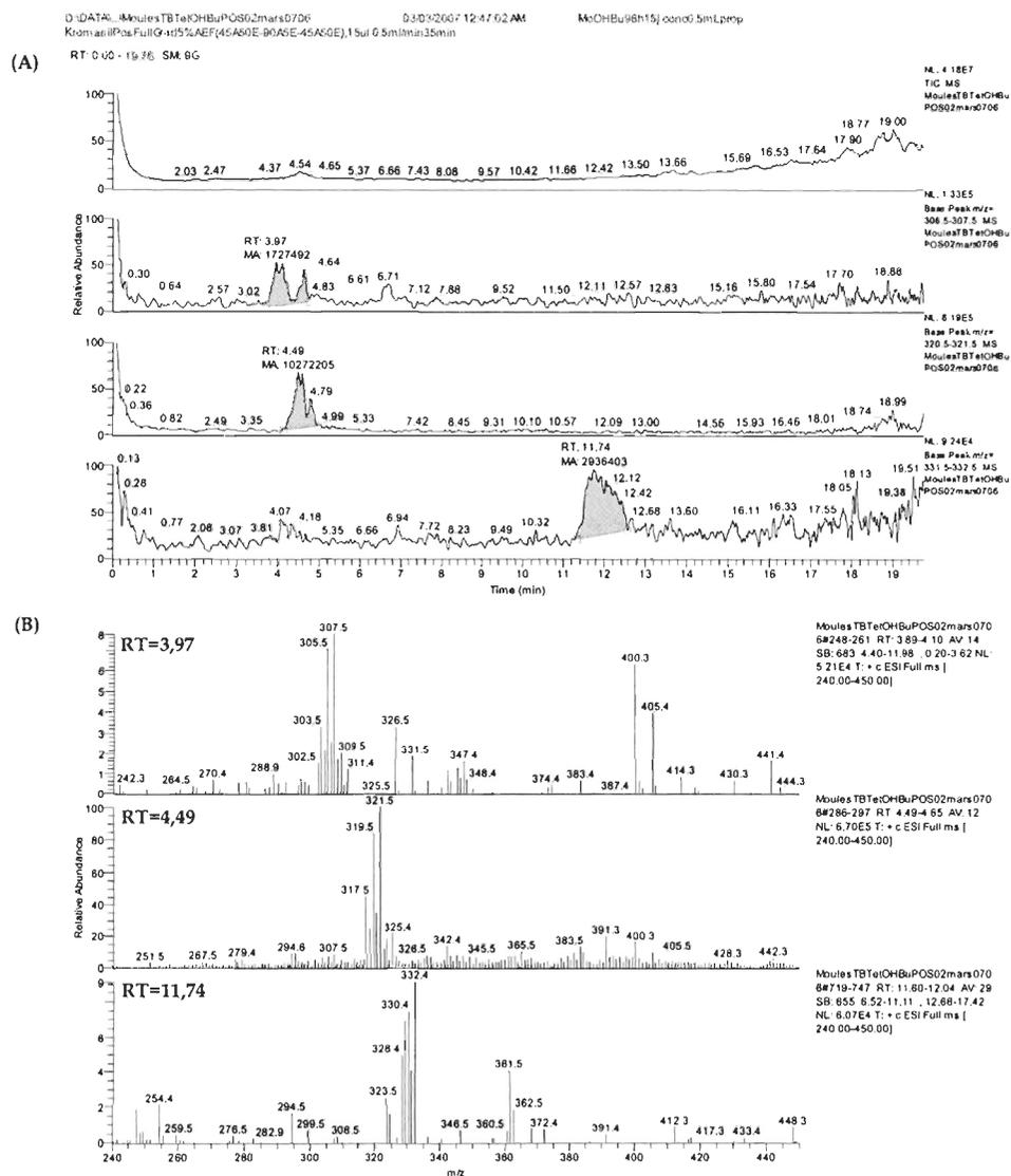
**Figure 3.** Chromatogrammes (A) et spectres de masse ESI positive (B) d'un extrait de tissus de moules ( $n = 2$ ) exposées 15 jours au 4-OHBUDBT (RT= 3,97 min), en mode de balayage complet du MS [ $m/z$  240-450]. Le pic à RT= 11,74 min correspond au TBT ( $m/z$  332) et le pic à (RT= 4,49 min) est un composé inconnu ( $m/z$  321).
