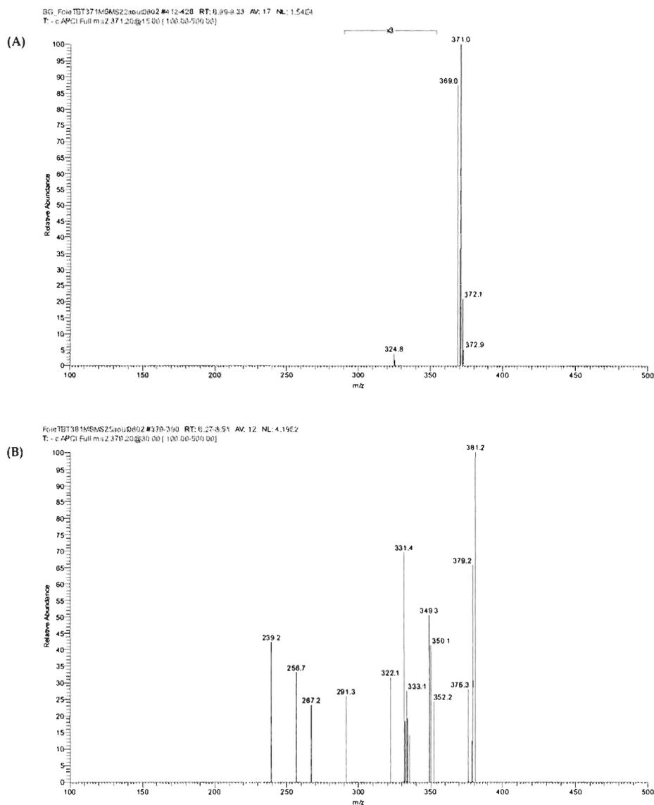
**Figure 13.** Spectres de masse APCI-MS/MS des ions  $m/z$  371 (A) et  $m/z$  381 (B) de l'extrait de foie de poisson exposé au TBT, avec une fenêtre d'isolation de masse de 6 amu et en mode de balayage complet du MS [ $m/z$  100-500].
