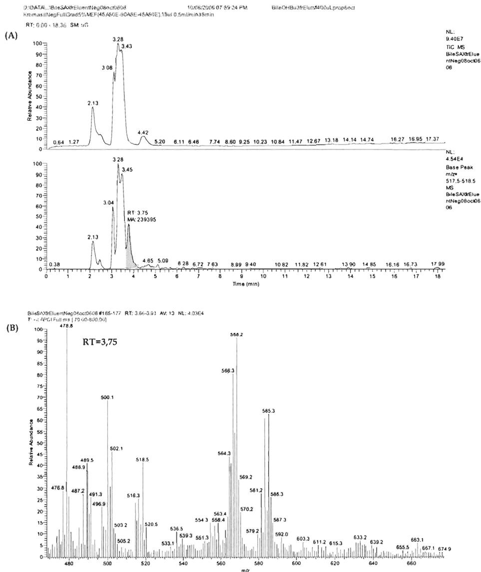
**Figure 12.** Chromatogrammes (A) et spectre de masse APCI négative (B) de l'extrait de bile de poisson exposé au 4-OHBuDBT révélant la présence d'un pic à RT= 3,75 min, correspondant à des ions non identifiés à  $m/z$  518, 558, 568 et 585, en mode de balayage complet du MS [ $m/z$  70-800].
