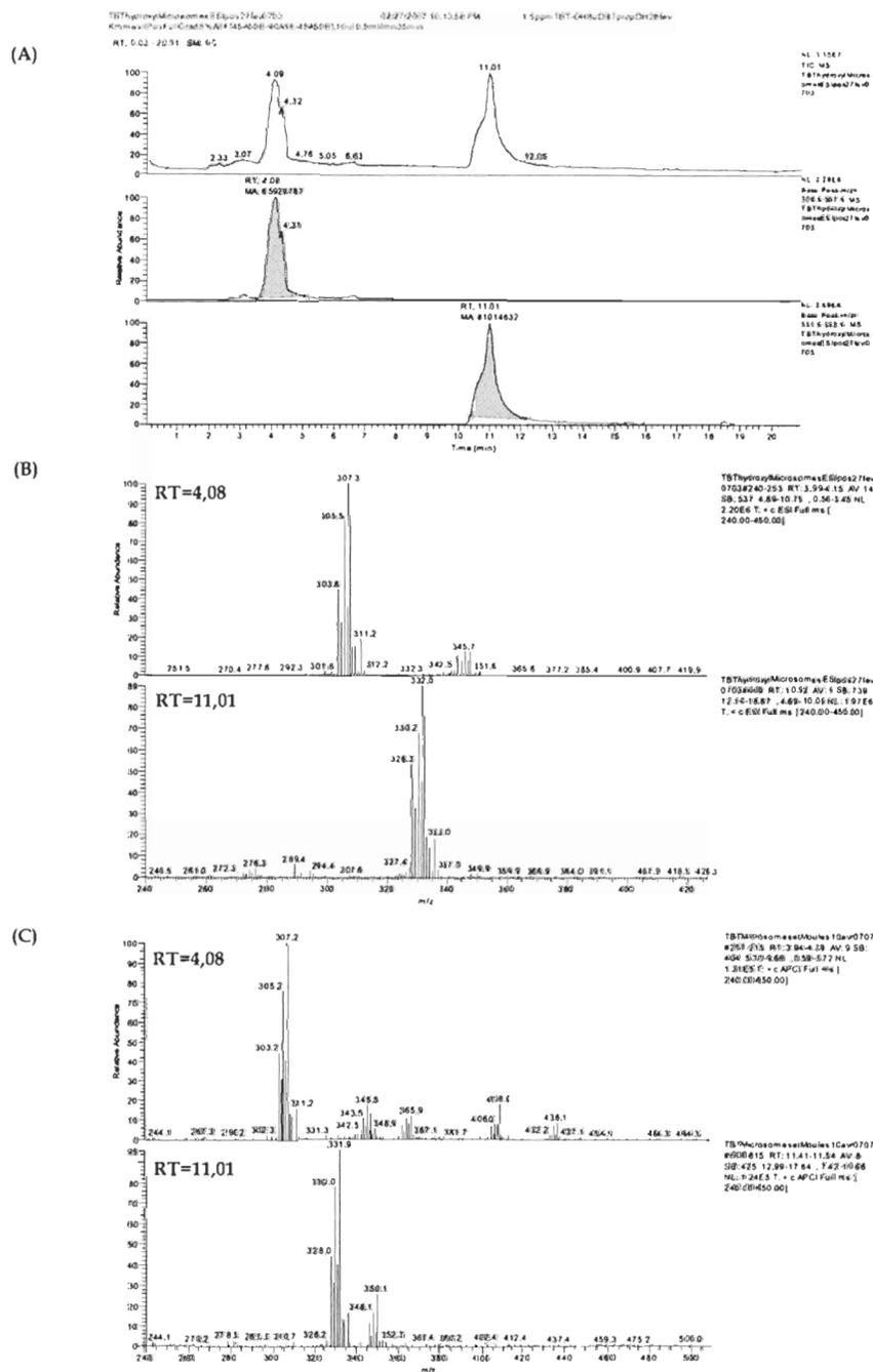
**Figure 3.** Chromatogrammes typiques en utilisant une colonne Kromasil C-18 (A) et les spectres de masse des standards (1,5  $\mu\text{g}\cdot\text{mL}^{-1}$ ) du 4-OHBuDBT (RT=4,08 min) et du TBT (RT=11,01) acquis en mode d'ionisation positif en ESI-MS (B) et en APCI-MS (C) avec un balayage des ions entre  $m/z$  240-450.
