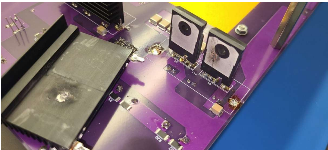
Figure A.13. Défaillance causée par un choix non adapté de composant lors de la conception
