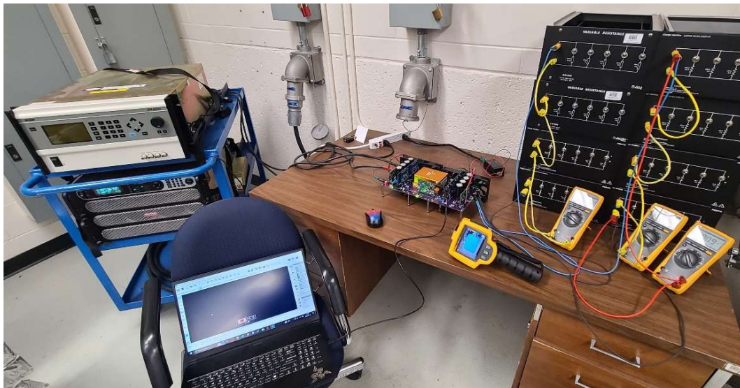
Figure A.12. Environnement de test haute tension, haute puissance avec une source de tension avec limitant de tension et de courant
