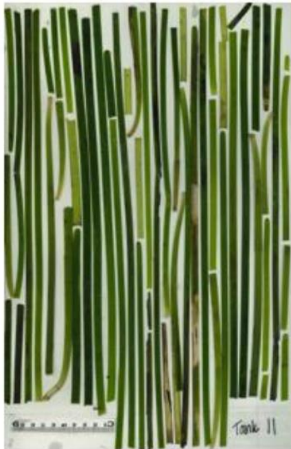
Figure 13 : Photocopie des plants d'un même échantillon pour l'estimation du LAI. Tous les segments des plants sont placés à plat sur une surface transparente ainsi que l'étiquette d'identification et une règle graduée. Cette figure est tirée de Tran (2019).
