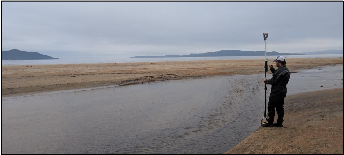
Figure 32. Prise de données avec DGPS Trimble © R10
