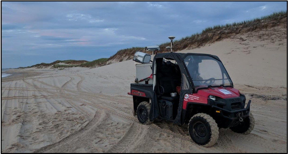
Figure 33. Système Mobile de LiDAR Terrestre du LDGIZC
