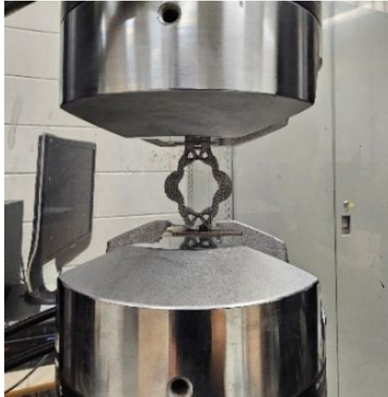
Figure 45: Mise en tension de l'éprouvette optimisée.
