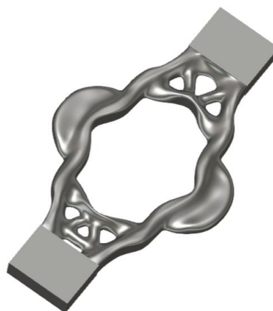
Figure 79 : Éprouvette optimisée choisie
