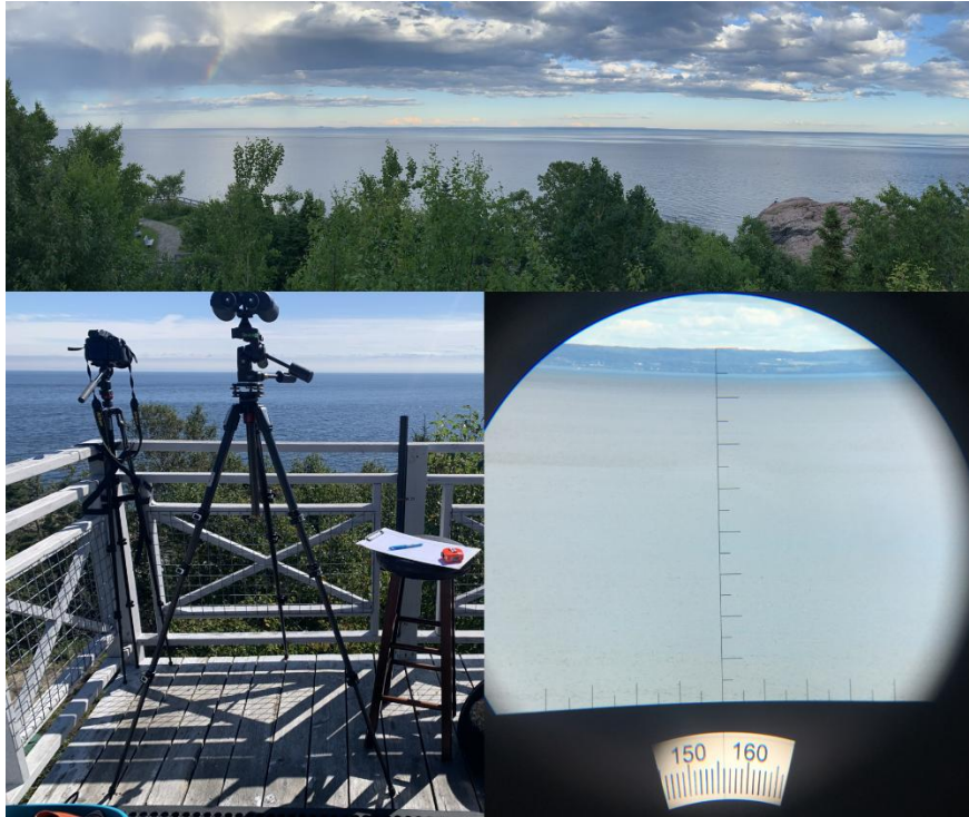
Figure 7. Photos de l'étendue visuelle de l'aire d'étude, de l'installation du matériel ainsi que les angles et réticules vus par l'objectif des jumelles télémétriques servant à positionner les observations. © Coralie Bernier-Breton. Reproduit avec permission.
