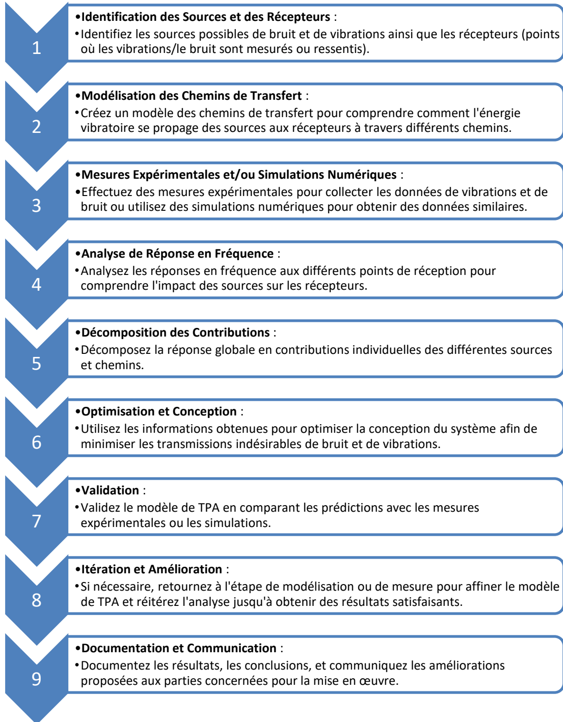
Figure 2. Schéma d'analyse systématique et de résolution des problèmes NVH à travers la TPA.
