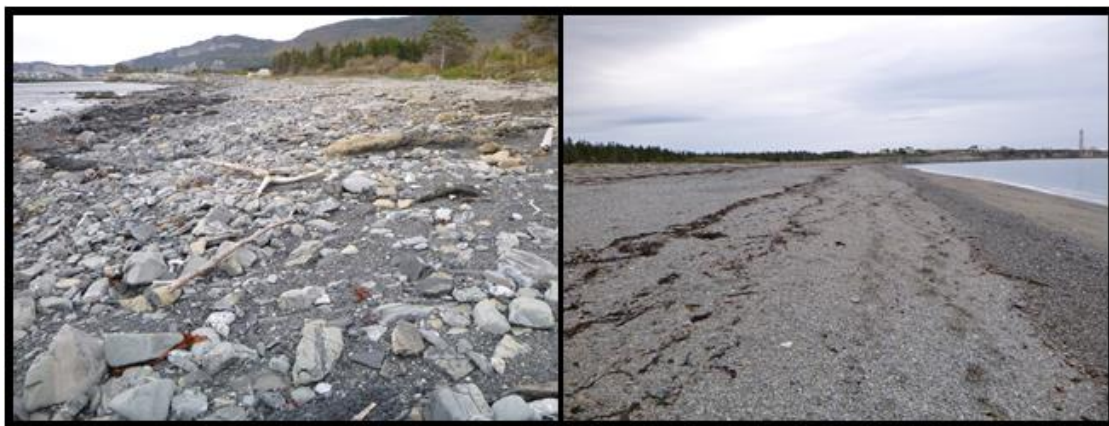
Figure 69. Carence en substrat fin ( D_{50} = 2,5 - 6,5 \text{ mm} ) sur le profil n° 30 à gauche en comparaison avec le profil n° 9 à droite le 28 septembre 2019.
