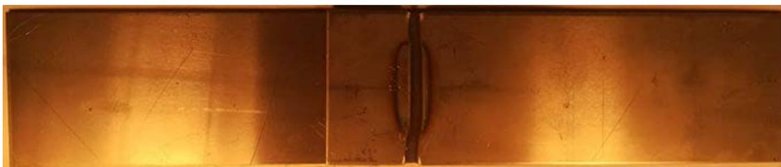
Figure 26 : Patron 13 - Fissure se propageant dans la plaque, côté envers
