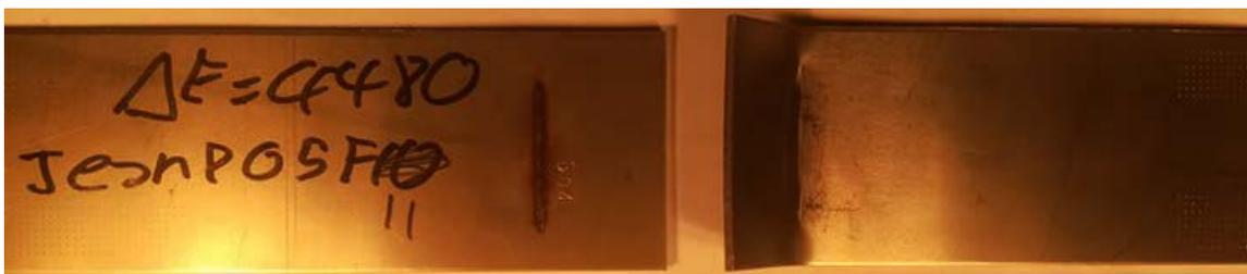
Figure 22 : Patron 5 - Fissure se propageant dans la plaque, côté envers
