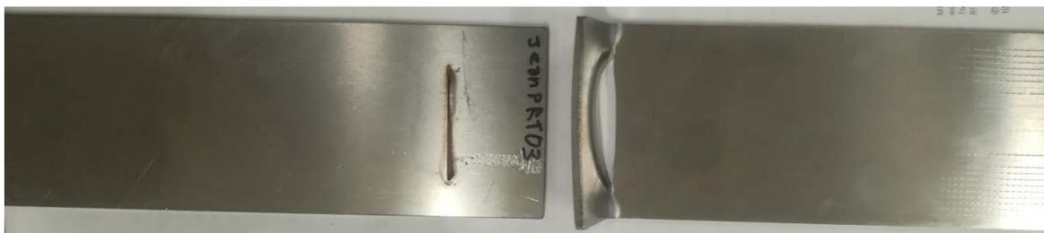
Figure 17 : Patron 2 - Fissure se propageant dans la plaque, côté envers
