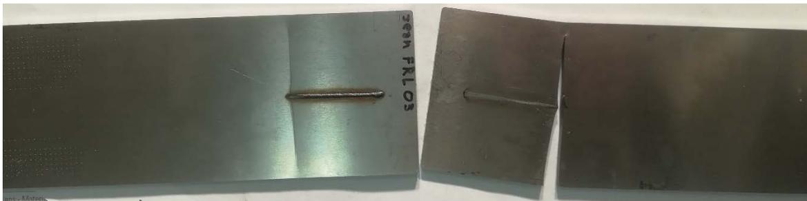
Figure 16 : Patron 1 - Fissures se propageant dans la plaque, côté envers, et la soudure
