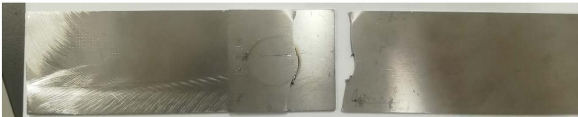
Figure 24 : Patron 7 - Fissure se propageant dans la plaque, côté envers
