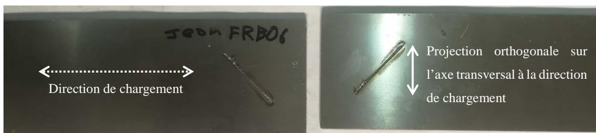
Figure 18 : Patron 3 - Fissure se propageant le long de l'interface soudée
