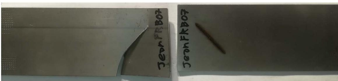
Figure 19 : Patron 3 - Fissures se propageant dans la plaque, côté envers, et la soudure
