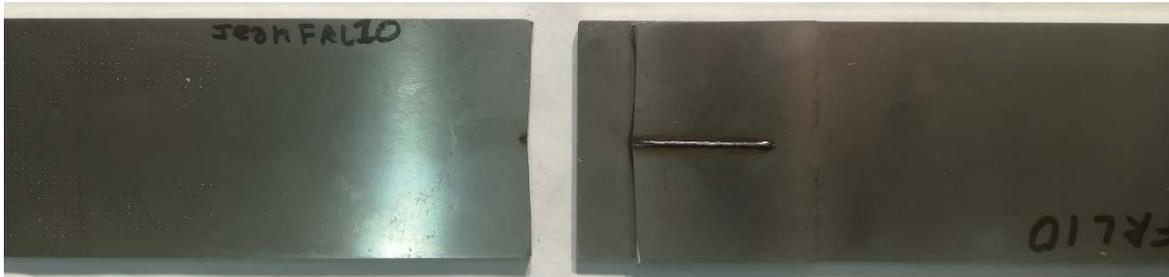
Figure 15 : Patron 1 - Fissure se propageant dans la plaque, côté endroit
