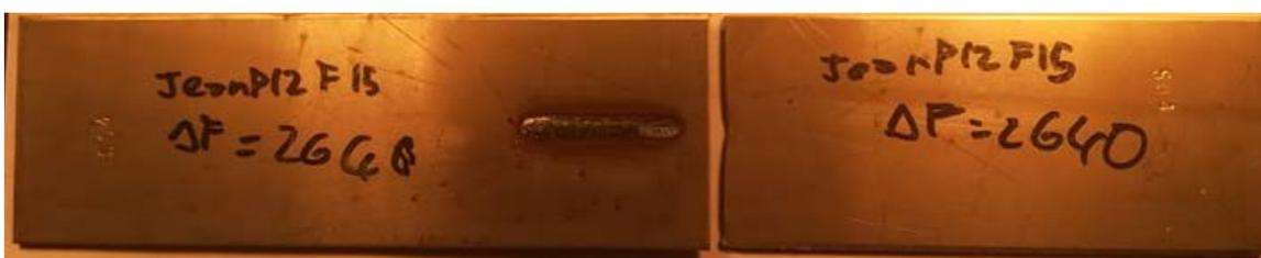
Figure 25 : Patron 12 - Fissure se propageant dans la plaque, côté envers
