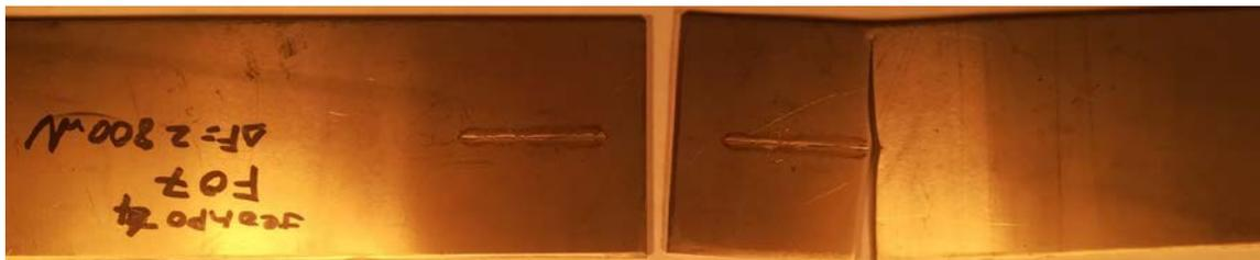
Figure 21 : Patron 4 - Fissures se propageant dans la plaque, côté envers, et la soudure
