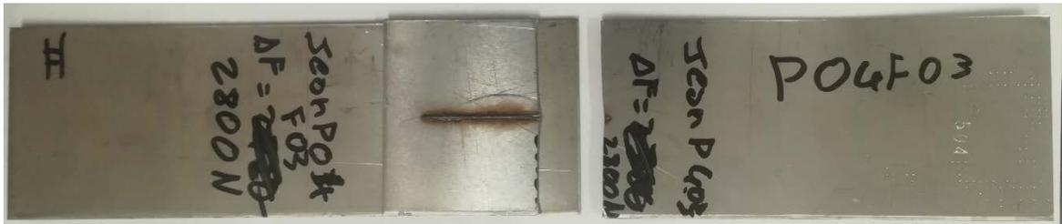
Figure 20 : Patron 4 - Fissure se propageant dans la plaque, côté endroit
