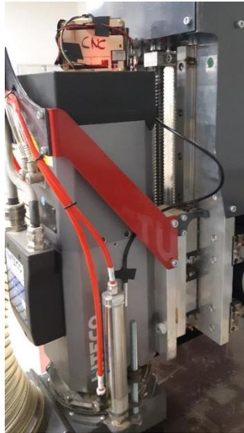
Figure 45. Capteur de température monté sur la broche du CNC.
