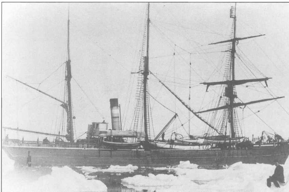
Le SS Diana , construit à Dundee en 1870, était un baleinier en bois, mu à voile et à vapeur. Il pouvait transporter 473 tonnes de marchandises et ses chaudières développaient jusqu'à soixante-dix chevaux vapeur (collection Marcel Lamoureux).
