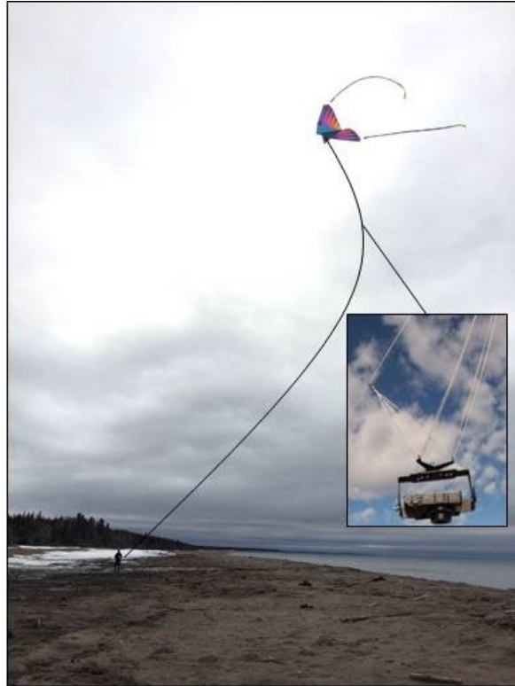
Figure 3. 9 Système d'acquisition des images par cerf-volant
