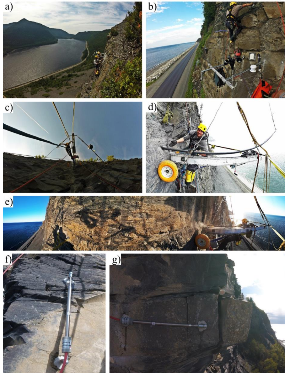
Figure 3. a) Station micrométéorologique de l'ANP avec en arrière-plan le talus d'éboulis, la route nationale 198 et le lac de l'Anse-Pleureuse ; b) station micrométéorologique installée sur la paroi rocheuse dynamitée de MAR avec la route nationale 132 en arrière-plan ; c) vue de la foreuse stabilisée sur la paroi rocheuse dynamitée de CAR ; d) tige de thermistances de 550 cm insérée dans un puit de forage horizontal sur la paroi rocheuse de MAE ; e) vue latérale de la foreuse en opération sur la paroi rocheuse de MAE avec la route nationale 132 en arrière-plan ; f) extensomètre vertical encadrant un segment de siltstone hautement altéré sur la paroi rocheuse de GMO ; et g) extensomètre horizontal positionné dans une strate de grès avec une fracture persistante et ouverte dans le haut de la strate.
