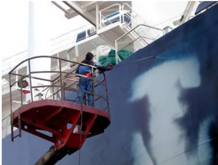
Figure 31. Application de peinture par pulvérisation sans air sur le dessus des navires [58]
