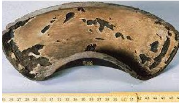
Figure 10. Erosion de corrosion sur la surface intérieure d'un tuyau coudé [15].
