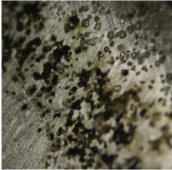
Figure 6. Exemple : Puits sur acier inoxydable 304 après exposition à un environnement marin simulé (3,5 g/L NaCl) [24].
