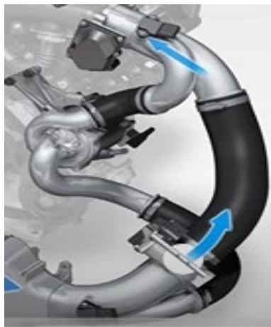
Figure 61 . Compresseur électrique en cas de repos
