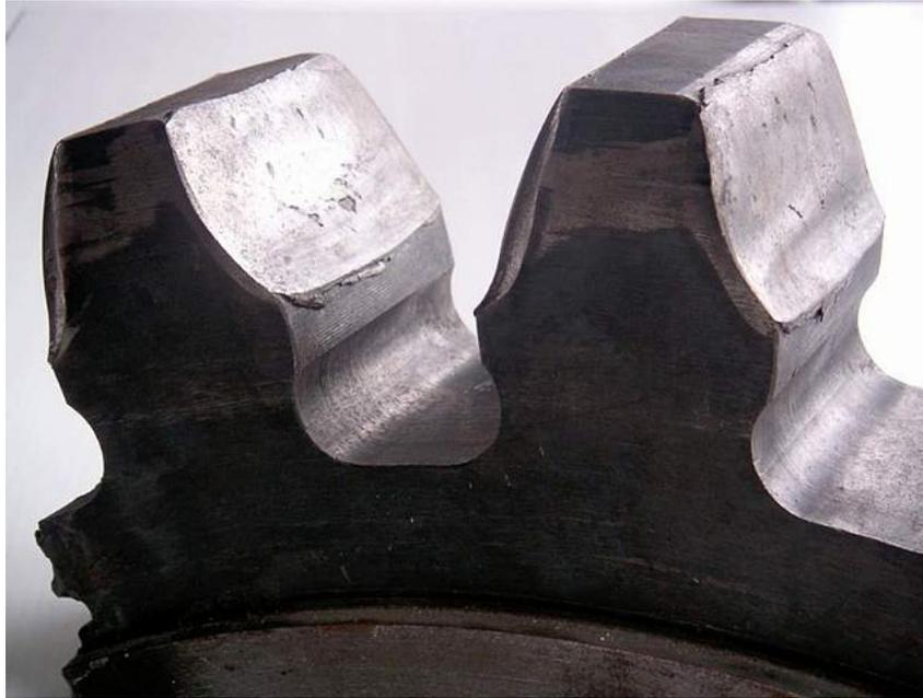
Figure 1 : Déformation plastique par roulage d'un engrenage
