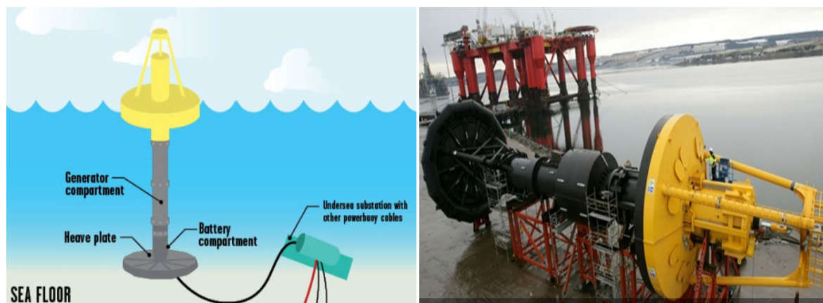
Figure 1.6 : Schéma explicatif de PowerBuoy et une photo du prototype PB3-A1 PowerBuoy.
