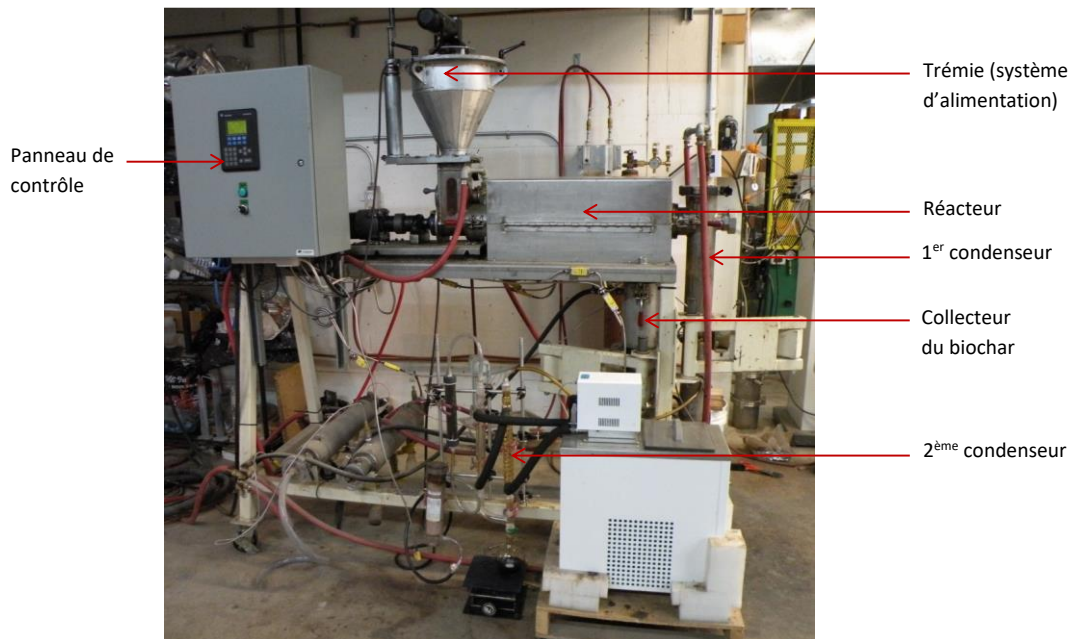
Figure 10: Unité de pyrolyse intermédiaire de type réacteur à vis sans fin du SEREX
