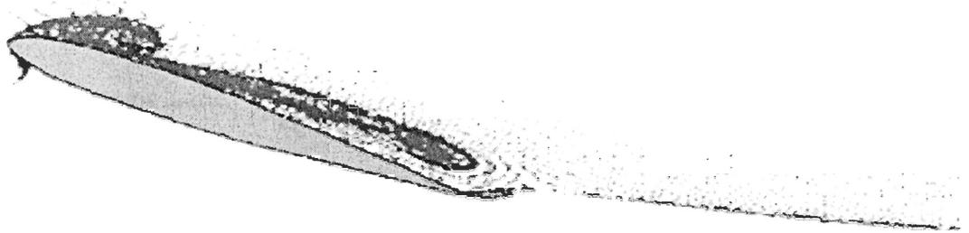
Figure 4: Mécanismes du décrochage aérodynamique- La séparation au niveau du bord d'attaque commence
