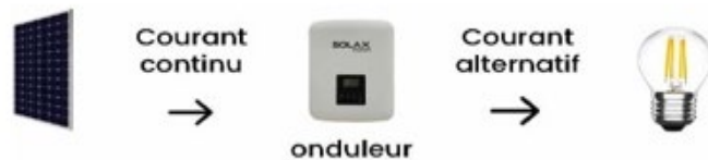
Figure 31: Principe de fonctionnement des onduleurs solaires [31]
